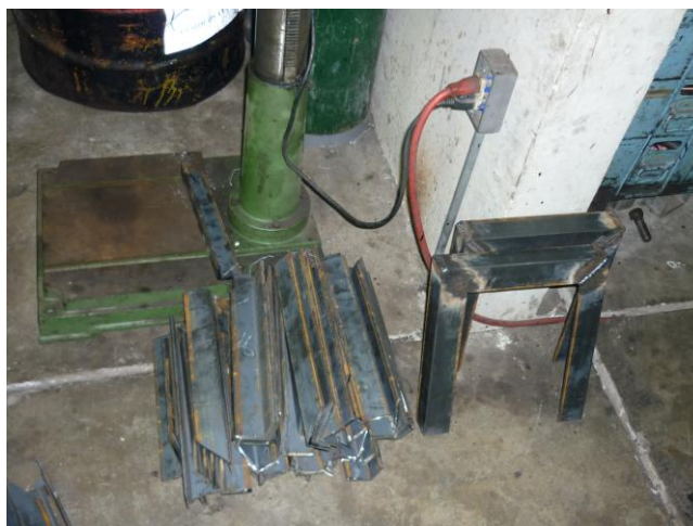
Imagen 7.2: Corte de perfil L de 2" a 45° y soldadura de estructuras.
