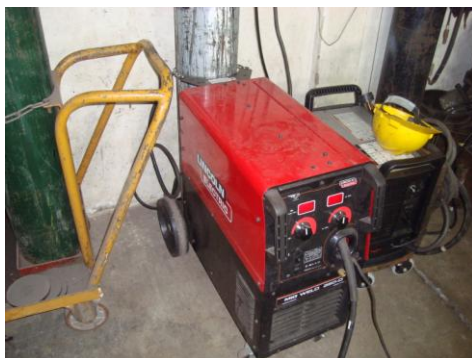
Imagen 7.29: Equipo de soldadura MIG, de la central Guangopolo.
