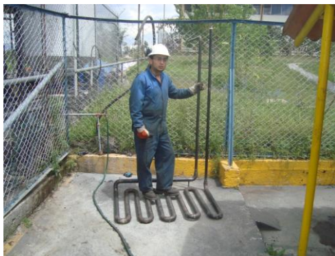
Imagen 7.27: Relación dimensional del serpentín de la fosa.
