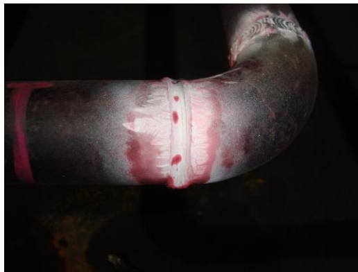
Imagen 7.43: Detección de pequeñas porosidades en un cordón de soldadura dentro del tanque API2.
