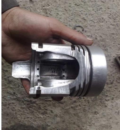
Figura 3.21. Corte de la cabeza del pistón
