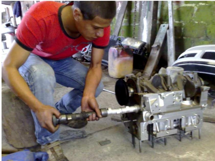
Figura 3.33. Montaje del eje de levas
