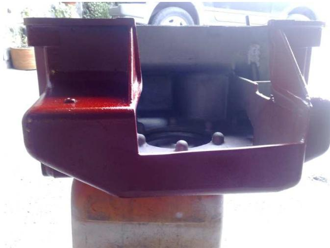
Figura 3.20. Corte del cárter de aceite
