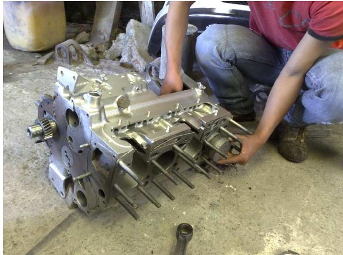
Figura 3.32. Montaje de los pistones
