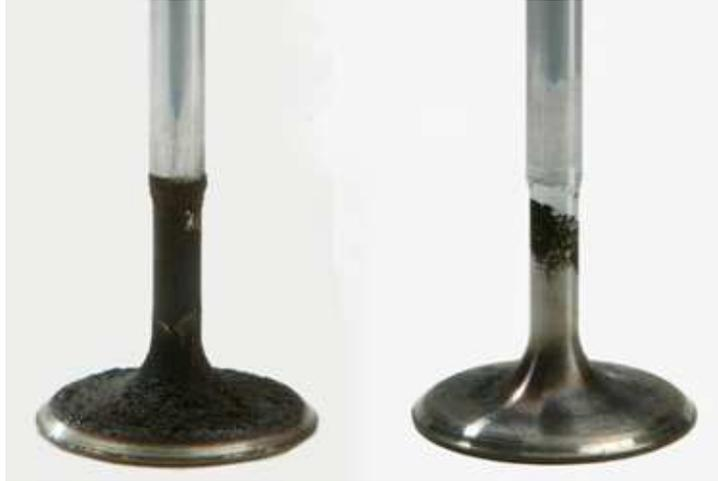
Figura 2.5. Válvula de escape desgastada por la combustión
