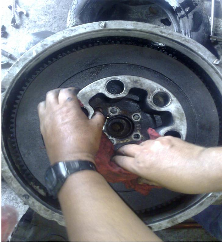
Figura 3.6. Desmontaje del volante
