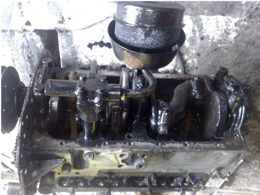
Figura 3.11. Desmontaje de la bomba de aceite
