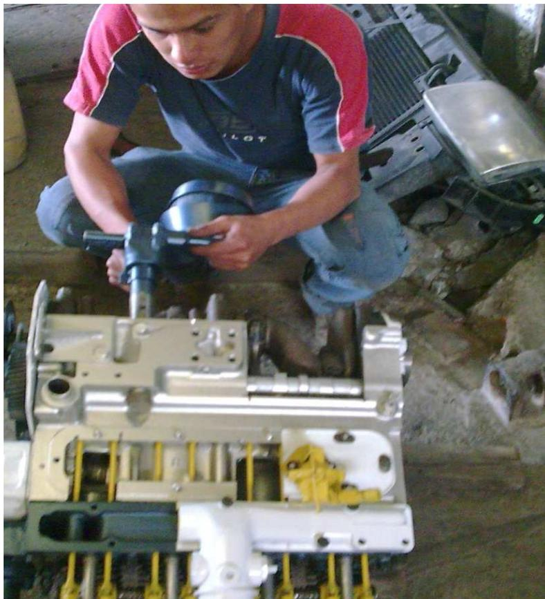
Figura 3.38. Montaje de la bomba de aceite
