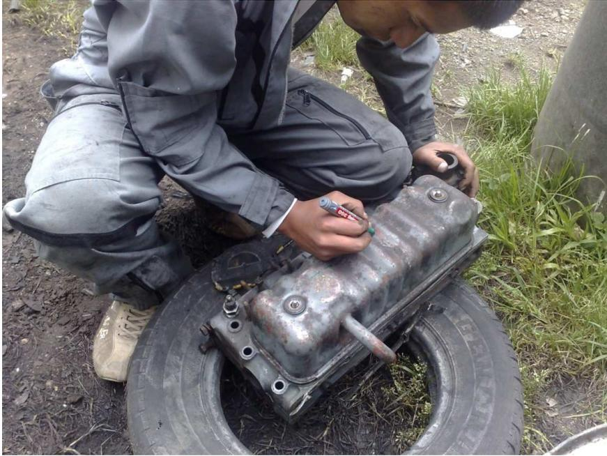
Figura 3.16. Señalización de los elementos a ser seccionados
