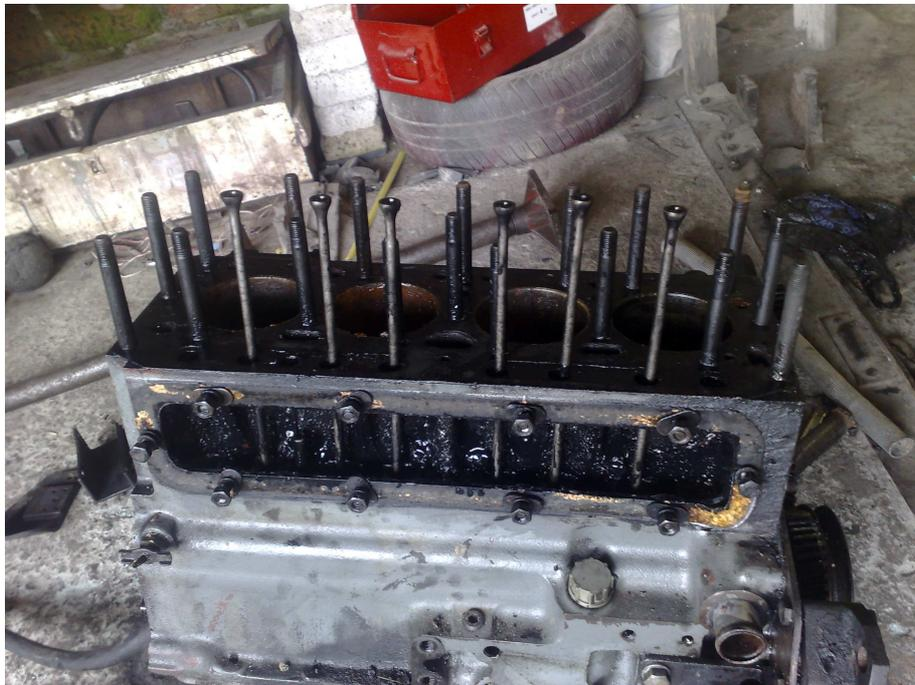
Figura 3.3. Desmontaje de la culata
