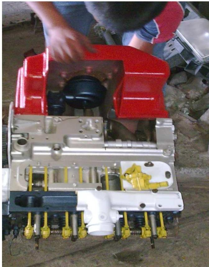
Figura 3.39. Montaje del cárter de aceite
