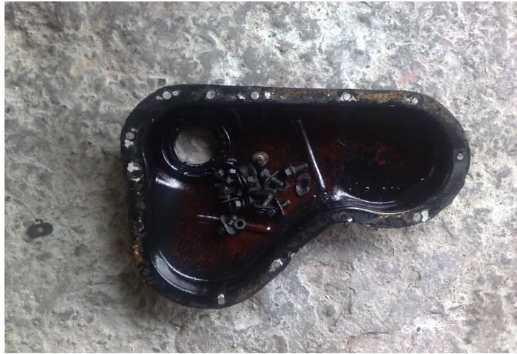
Figura 3.12. Remoción de la tapa que recubre los engranajes de sincronización
