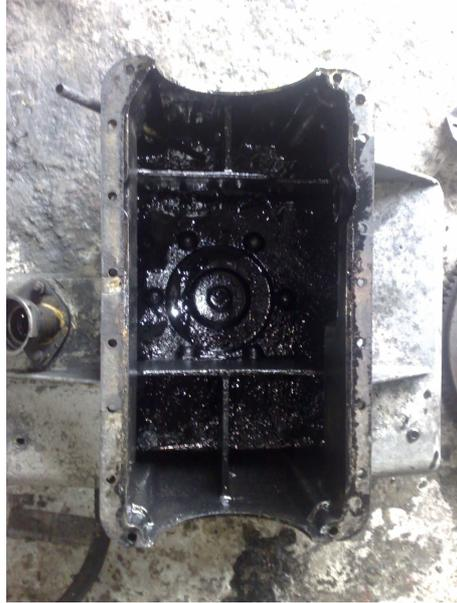
Figura 3.9. Remoción de los pernos que sujetan el cárter al bloque
