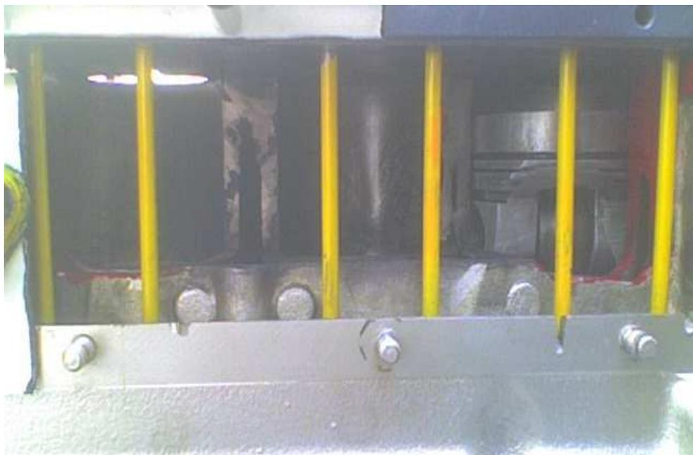
Figura 3.19. Corte del bloque sección cilindros
