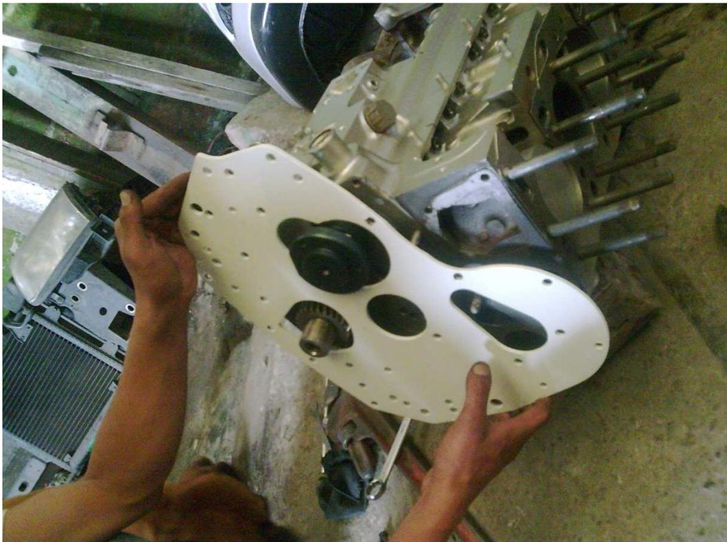
Figura 3.35. Tapa de engranes de sincronización
