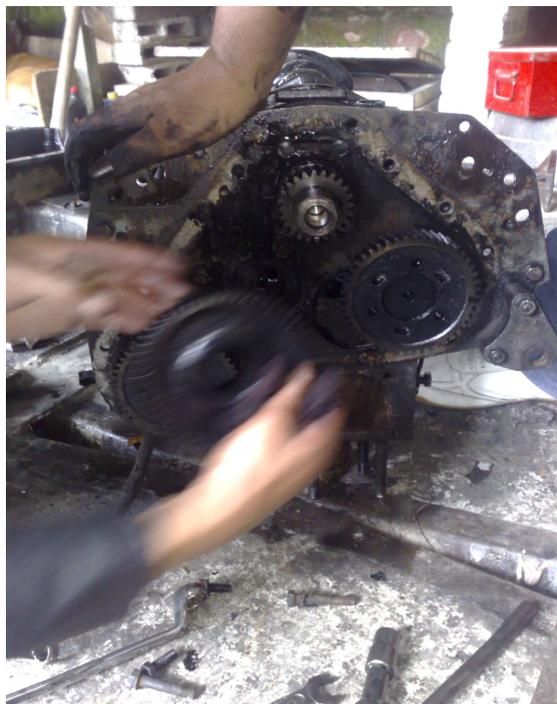
Figura 3.13. Desmontaje del engranaje central
