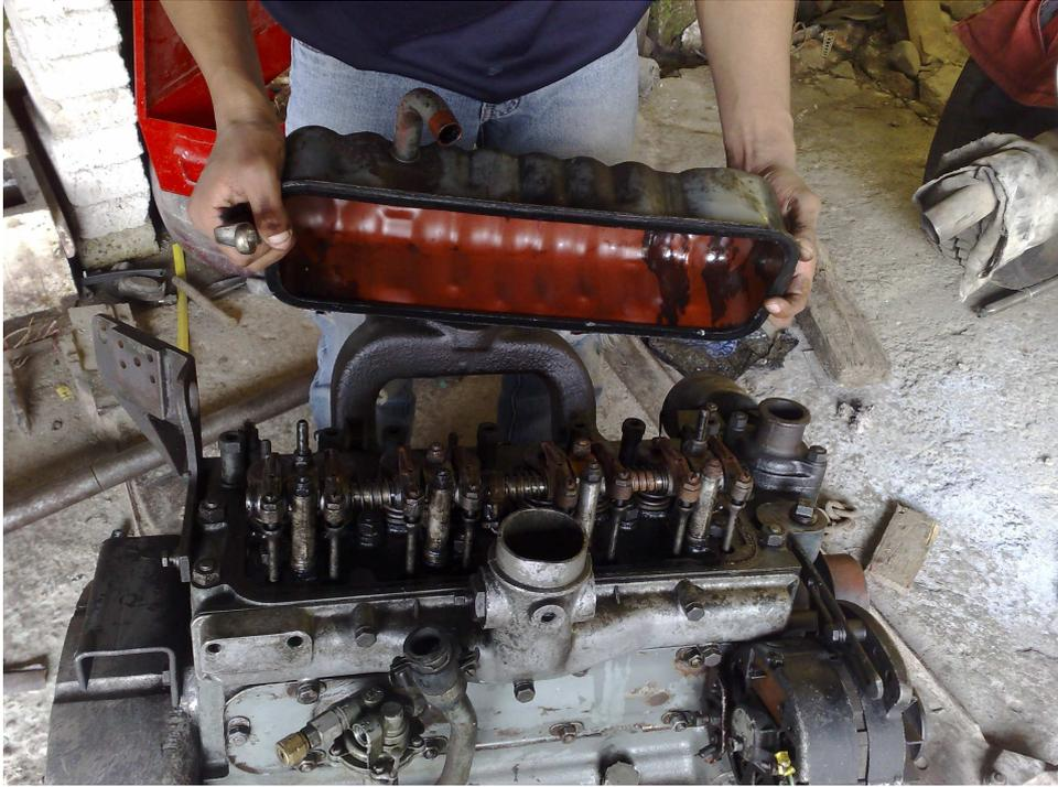
Figura 3.2. Desmontaje de la tapa cubre balancines
