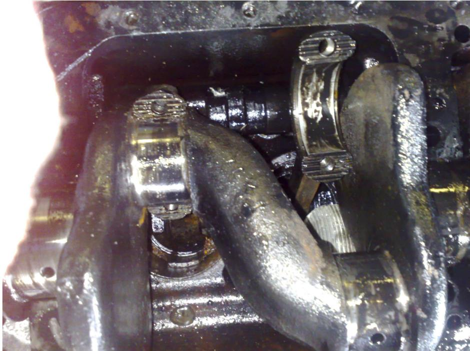
Figura 3.15. Desmontaje del cigüeñal
