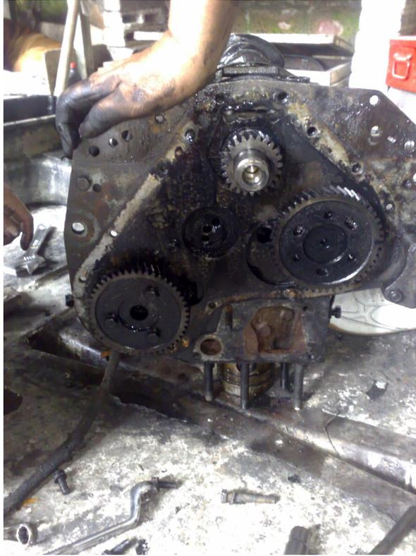
Figura 3.14. Desmontaje de los engranajes de sincronización
