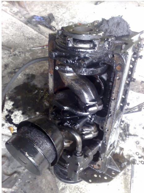
Figura 3.10. Desmontaje del cárter de aceite
