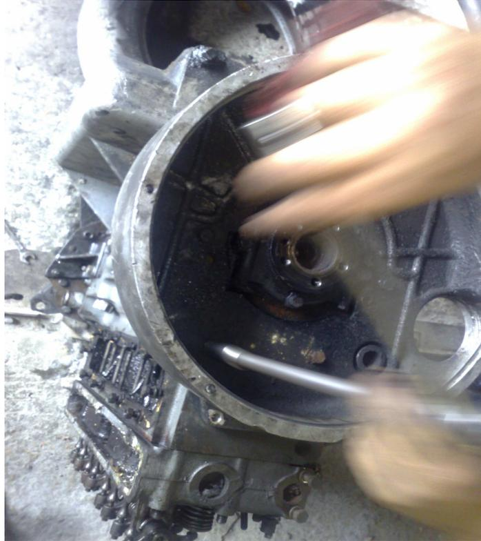
Figura 3.7. Desmontaje de la tapa que cubre el volante
