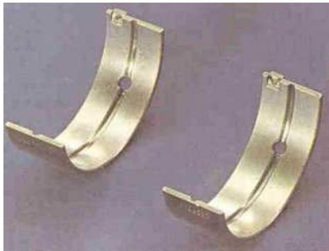
Figura 2.12. Cojinetes perforados para la lubricación
