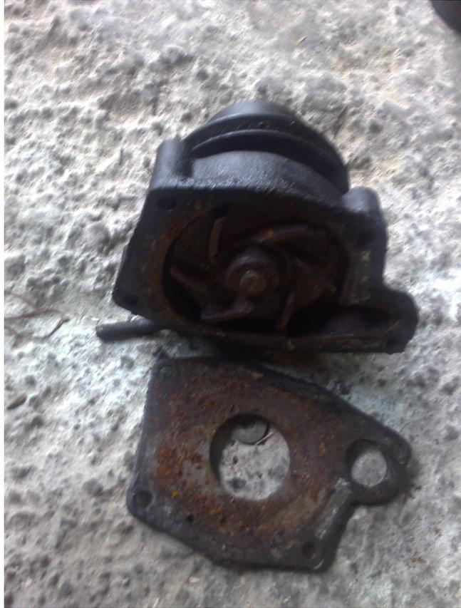
Figura 3.8. Desmontaje de la bomba de agua
