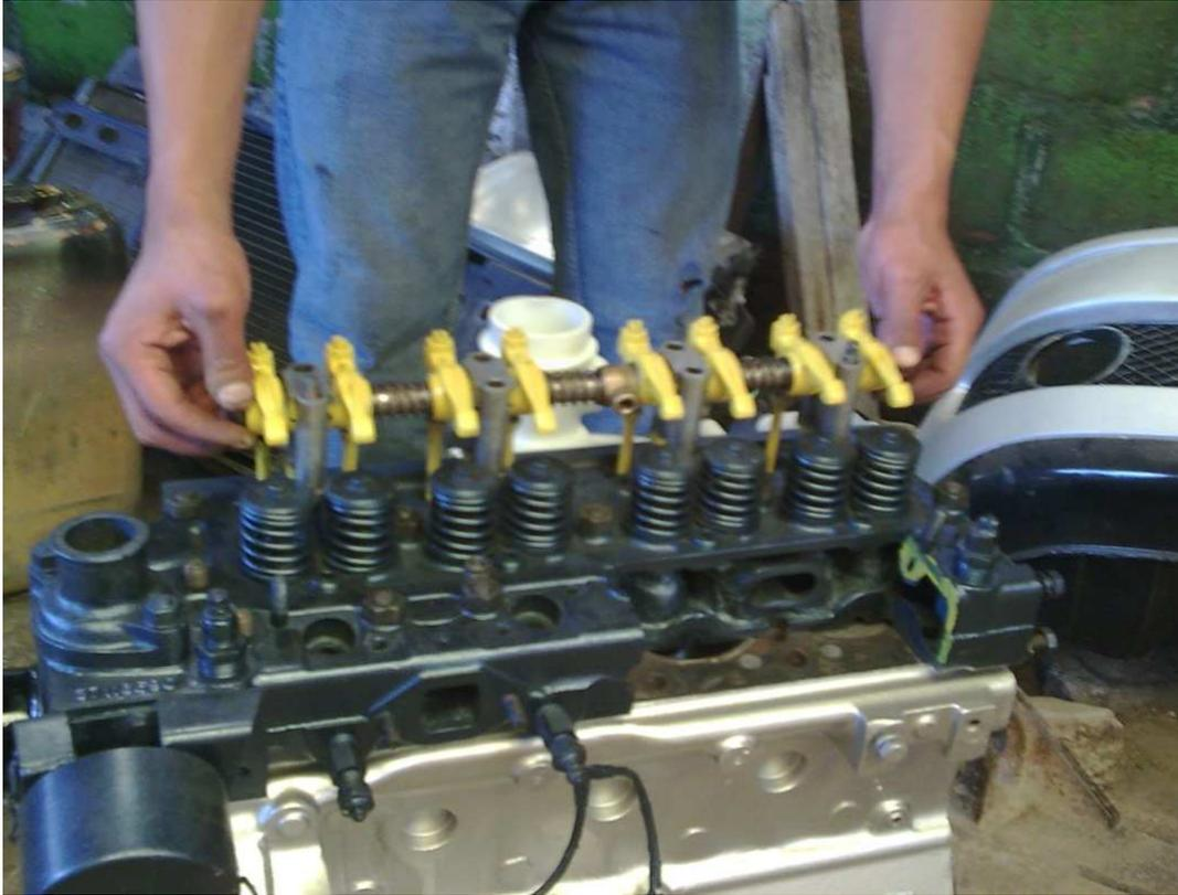
Figura 3.37. Montaje de los balancines
