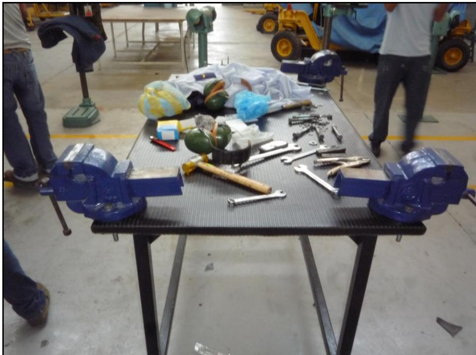
Foto 6.62 Mesa de trabajo con recubrimiento de moqueta
