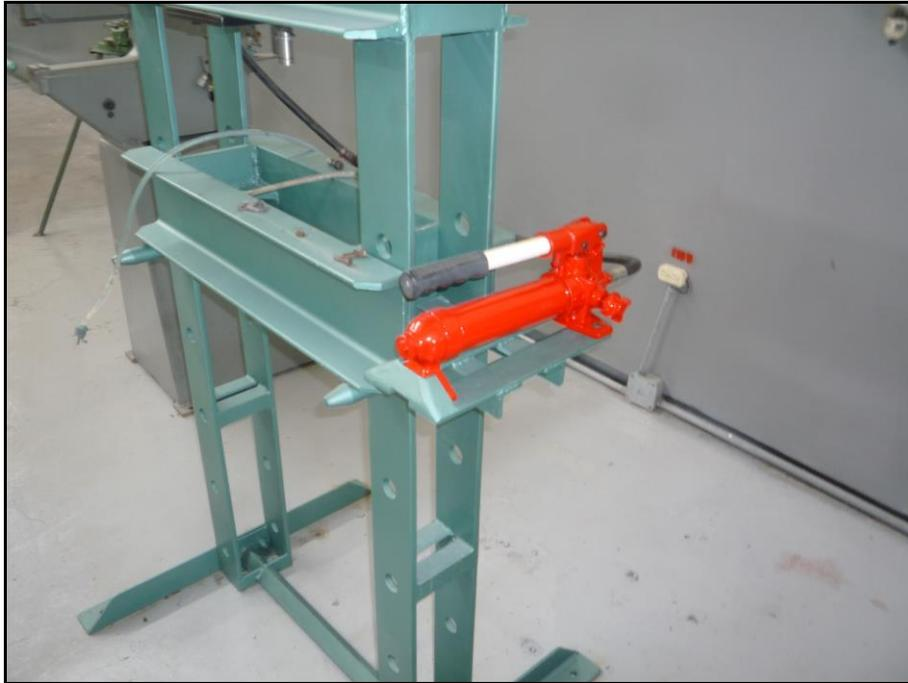
Foto 6.45 Pintado total de la prensa hidráulica
