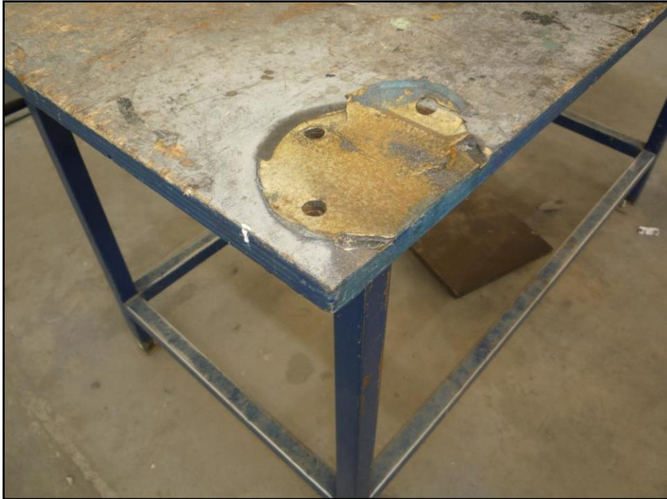
Foto 6.58 Desmontaje de las entenallas de las mesas de trabajo
