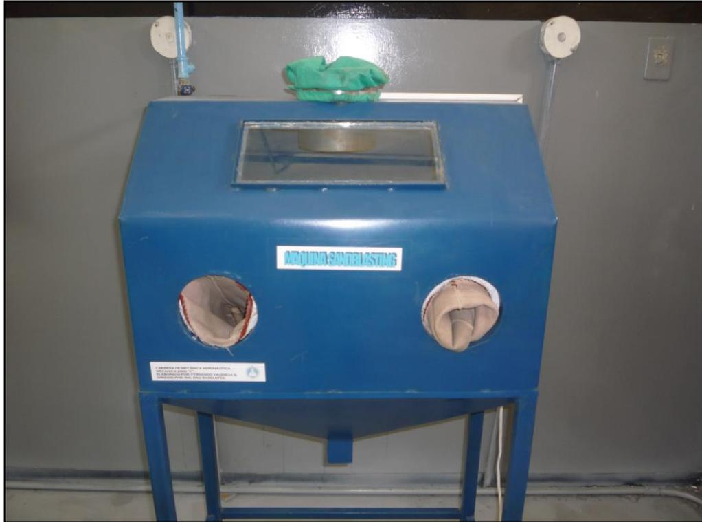
Foto 6.17 Estado actual de la máquina sandblasting
