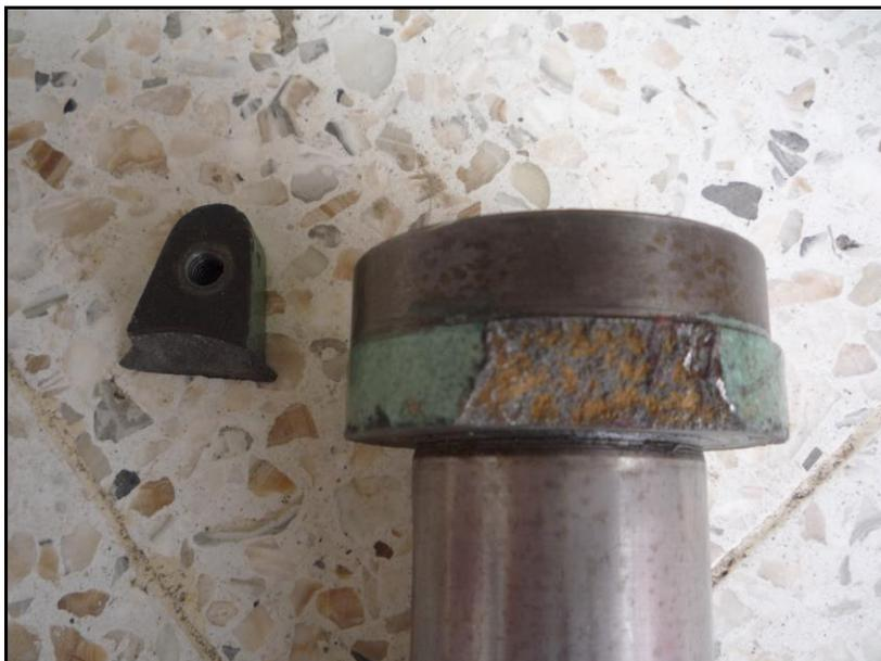
**Foto 6.24 Rotura de componente del taladro**
