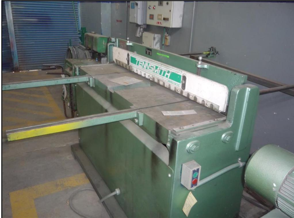
Foto 6.8 Estado actual de la cizalla hidráulica
