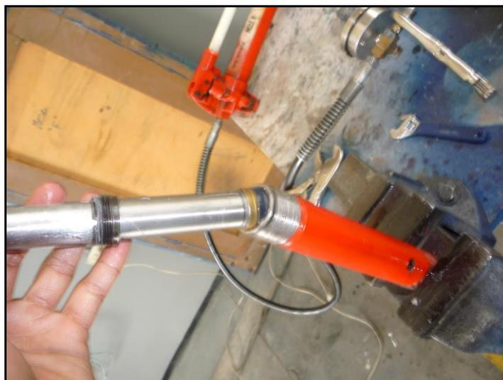
Foto 6.44 Reparación del cilindro hidráulico
