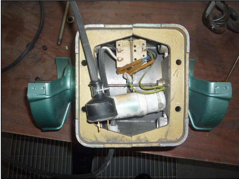
Foto 6.52 Reparación del sistema eléctrico de los esmeriles
