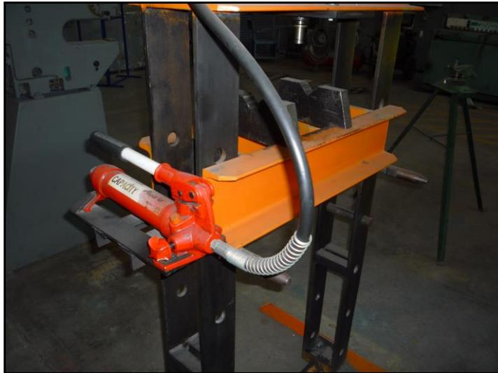
Foto 6.43 Sistema hidráulico de la prensa
