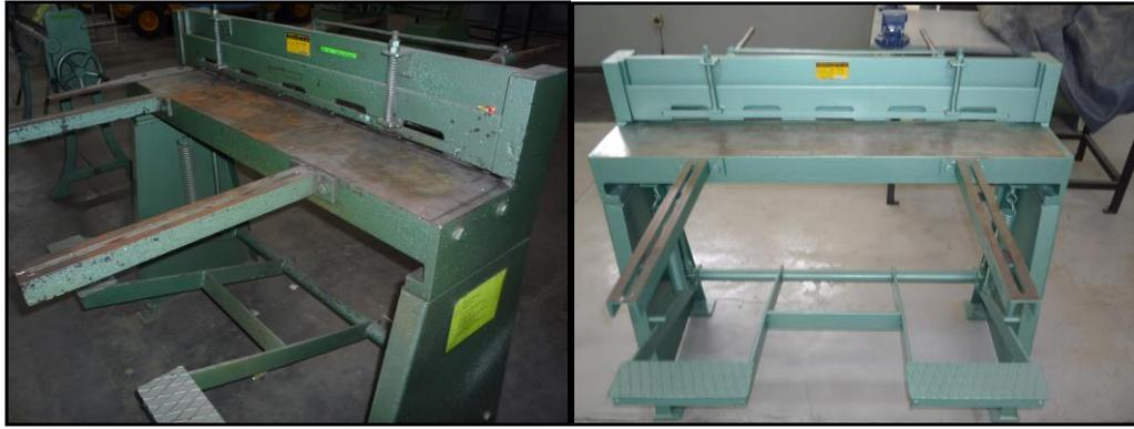
Foto 6.38 Pintado de la cizalla de pedal (antes-después)
