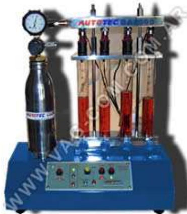
FIGURA 5.12: Banco para inyectores o antorchas (AUTOTEC BA2000)
