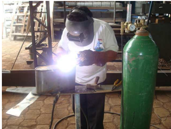
FIGURA 5.17: Construcción del tanque rectangular.
