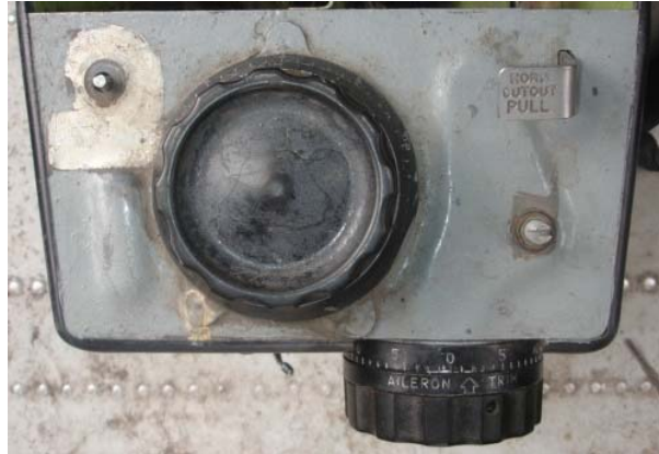
Fig. 10.- Aileron y Rudder Trim en mal estado con fisuras.
