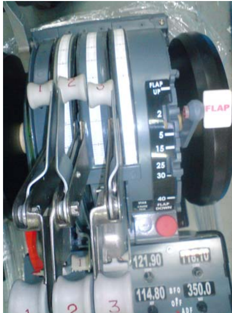
Fig. 62.- Stickers de indicación de palancas de potencia.
