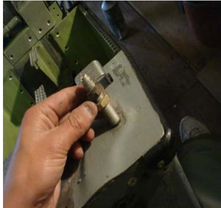
Fig. 30.- Perno que no pertenece al Stab Brake.
