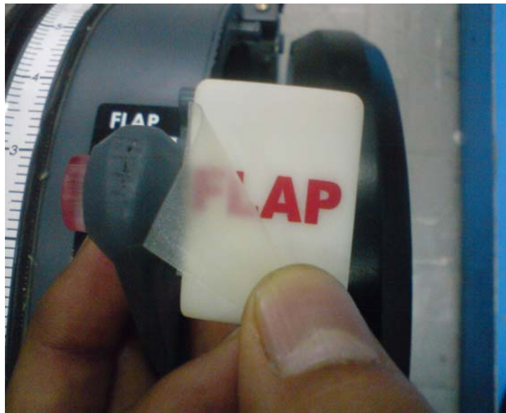
Fig. 54.- Extracción de cobertura de flap.
