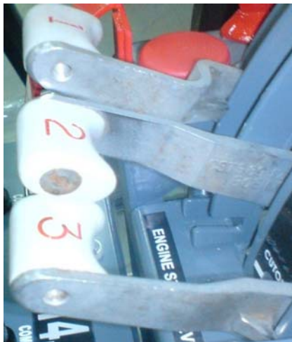
Fig. 49.- Palancas de ignición recubiertas con anodizador.
