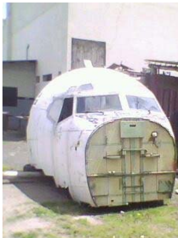
Figura Nº 1.- Cabina completamente desmantelada del Boeing 727-200
