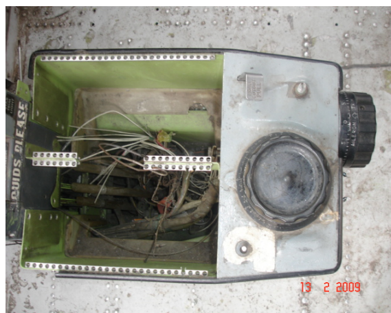
Fig. 5.- Panel de audio completamente desmantelado.
