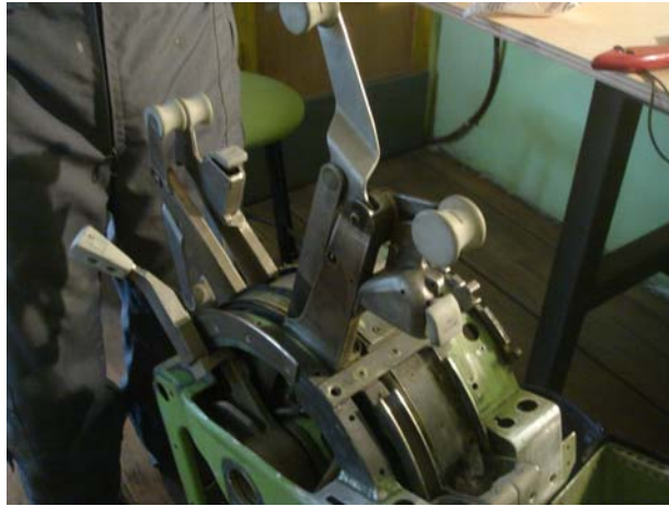
Fig. 16.- Limpieza total de palancas con Scotch Brite.
