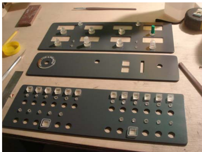
Fig. 40.- Construcción de Panel de Navegación, Panel de Piloto Automático y Panel de Comunicaciones.
