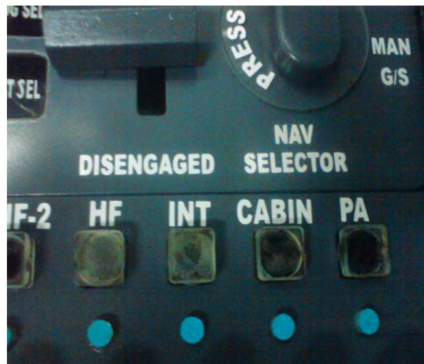
Fig. 59.- Stickers del Panel de comunicaciones
