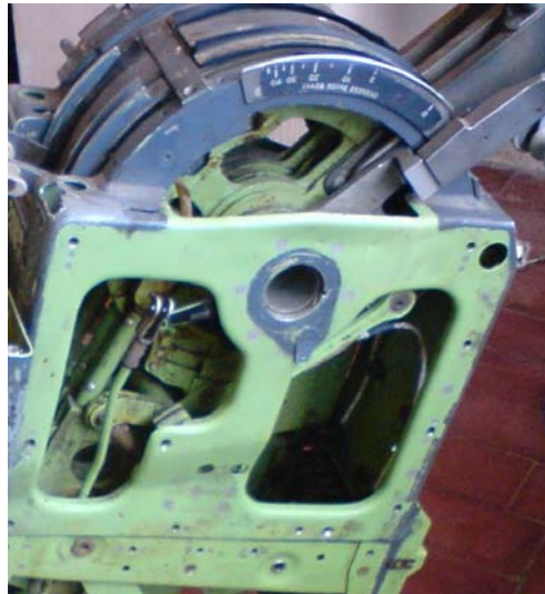
Fig. 33.- Mal estado en el interior antes del decapado.
