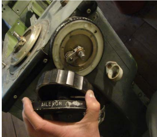
Fig. 22.- Desmontaje de la perilla del Aileron trim.
