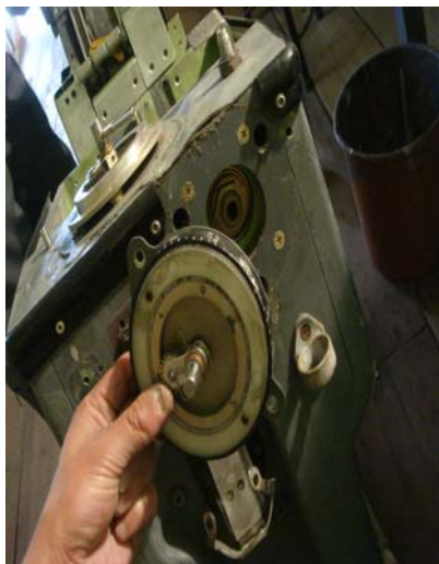
Fig. 23.- Desmontaje de la base del Aileron trim.
