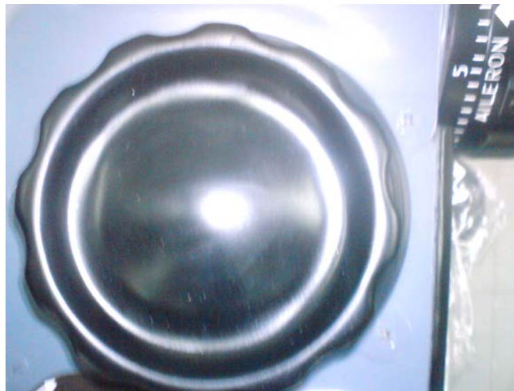
Fig. 42.- Perilla del rudder trim rehabilitada.
