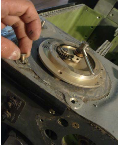
Fig. 20.- Desinstalación de la base del rudder trim.
