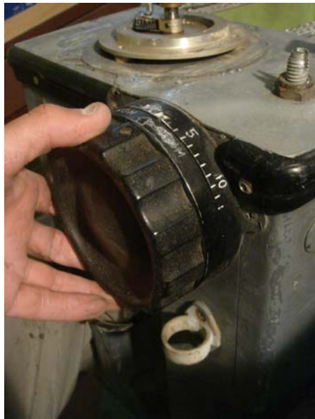
Fig. 21.- Mal estado de pintura del Aileron trim.
