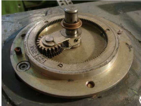
Fig. 18.- Desmontaje del rudder trim.
