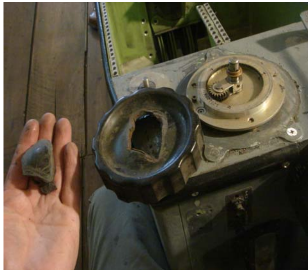
Fig. 19.- Perrilla rota del rudder trim.
