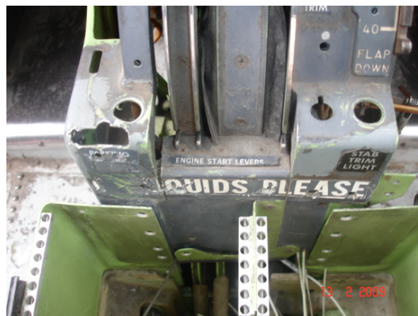
Fig.9.- Destrucción y rayadura en entradas de palancas.
