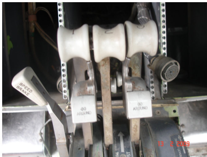
Fig. 7.- Palancas de potencia en mal estado corroídas.
