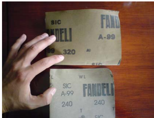
Fig. 32.- Lija 240, 320 usadas para evitar rayaduras.
