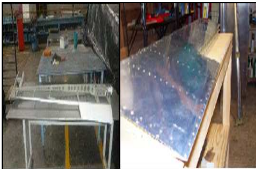
Figura 3.17: Armado estructural de los elevadores RH y LH.
