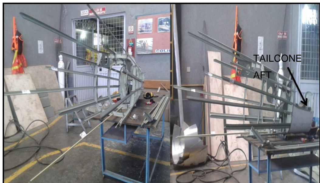
Figura 3.22: Armado estructural de la cola.
