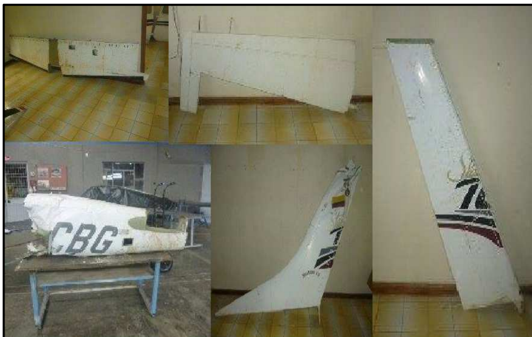
Figura 3.9: Desarmado y división del empenaje.
