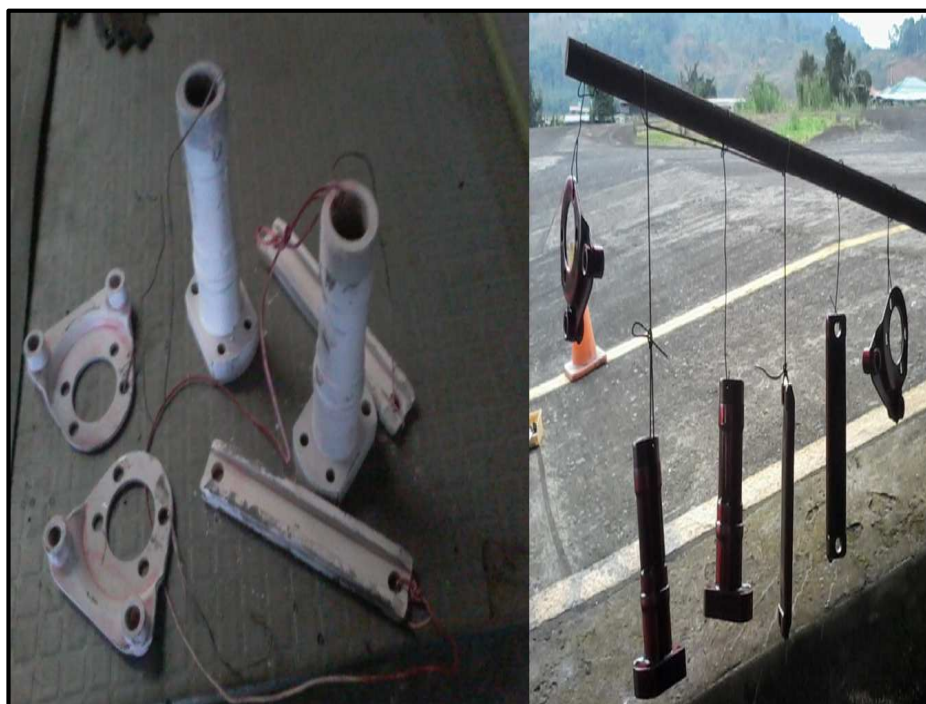
Figura 3.26: Aplicación de líquidos penetrantes.
