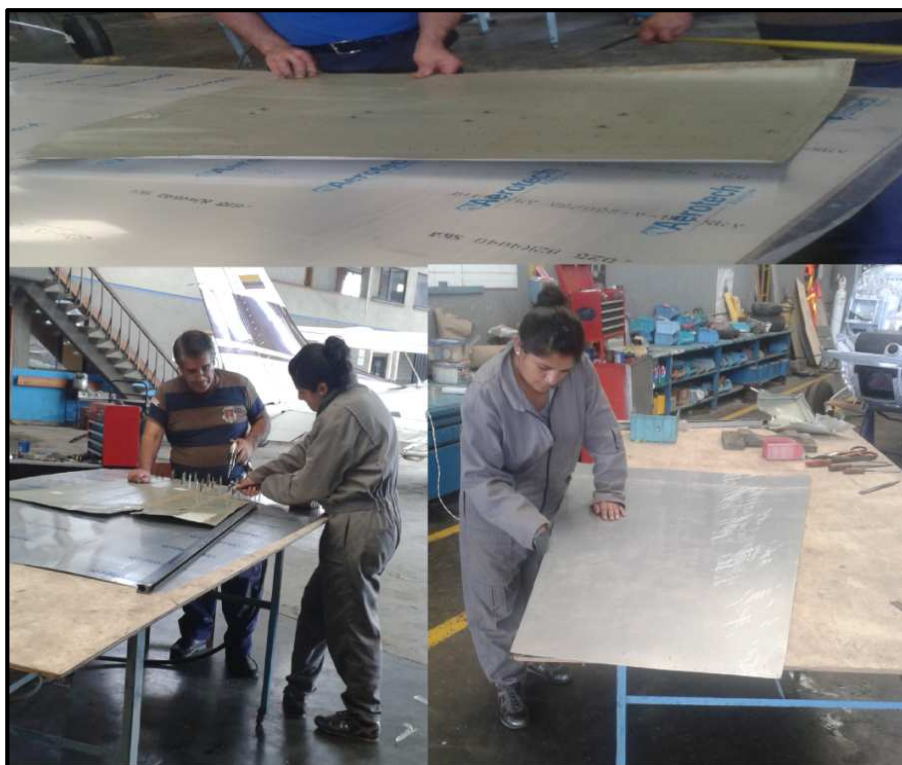
Figura 3.14: Proceso de reconstrucción de la piel.
