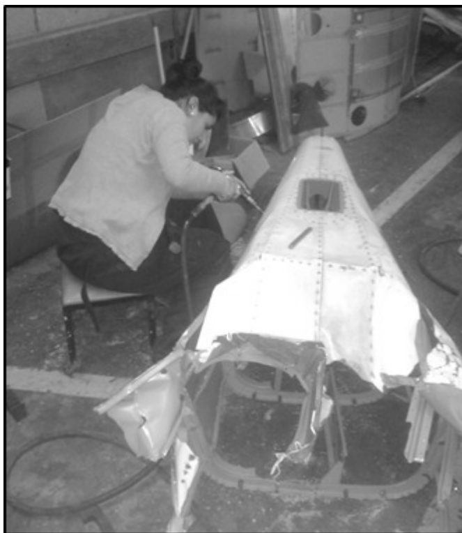
Figura 3.10: Taladrado sobre los remaches.
