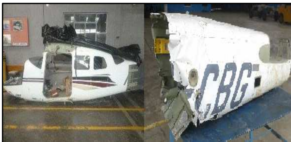
Figura 3.8: Separación del tailcone del fuselaje de la aeronave.
