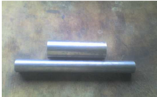
Figura 3.7 Varilla de acero de transmisión SAE 1018.
