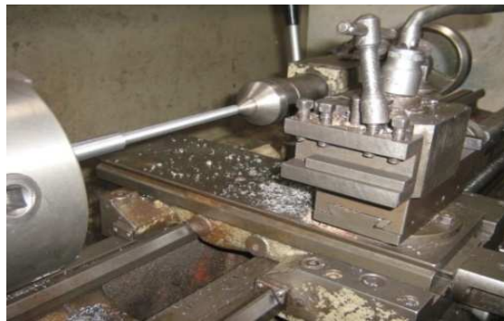
Figura.3.18 Proceso de rectificación de la varilla
