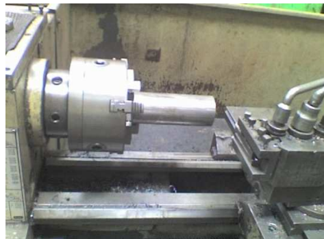
Figura 3.11. Proceso de sujeción del material.
