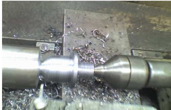
Figura 3.22 Proceso de desbaste de superficies semi redondas.
