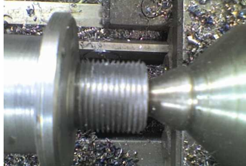
Figura 3.25 Proceso de roscado del material.
