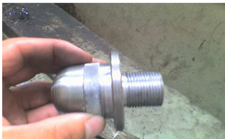
Figura 3.29 Soporte posterior terminado.
