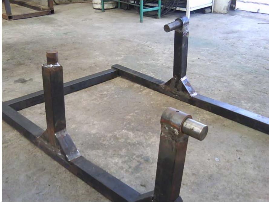
Figura Nº 5.13: Columnas de soporte de la estructura principal.
