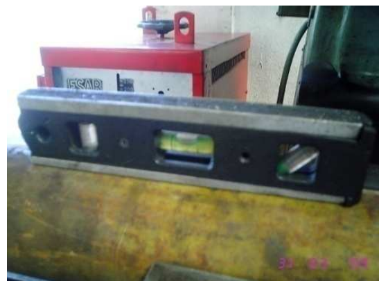
Figura No. 6.6 Nivelación Tubos
