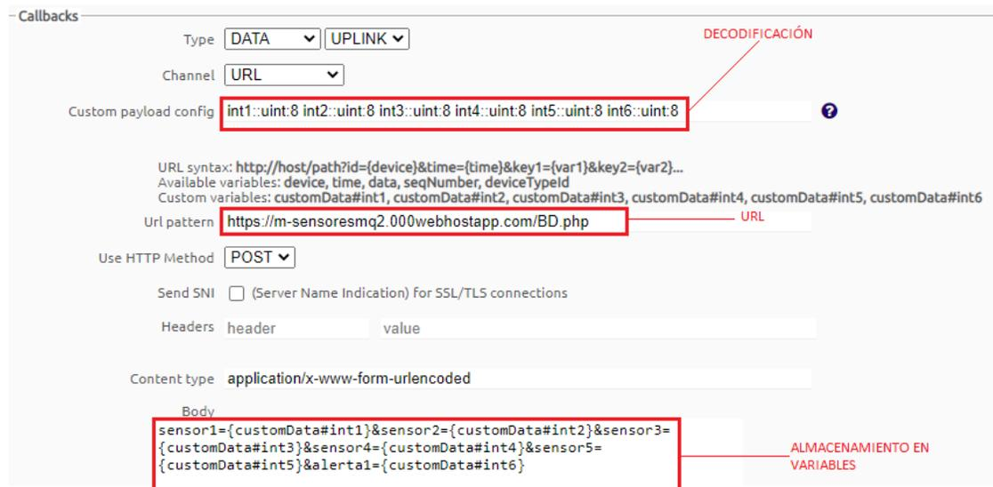
*Nota.* Adaptado de la configuración de Callbacks del Backend de Sigfox.
