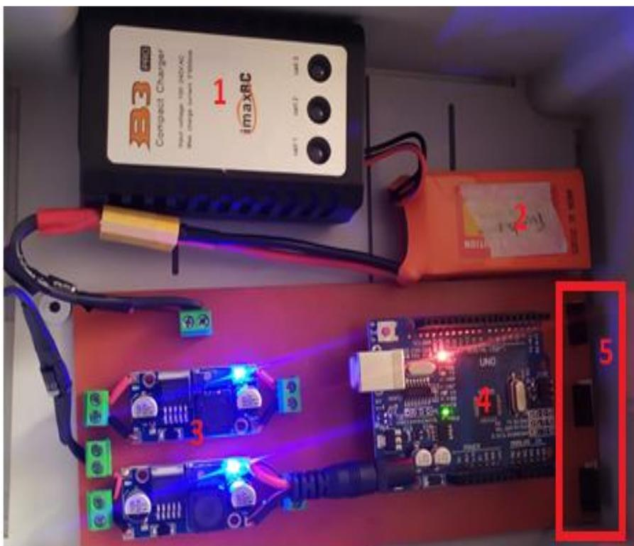
Se observa en la Figura 70 los circuitos finales instalados y conectados respectivamente para el envío de datos de los diferentes sensores que están conectados a cada caja del nodo central, en cada nodo se conectan cinco sensores.
