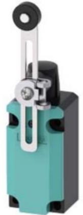
Sensor mecánico vástago de acero: Tensión asignada 24 ... 400 VDC, contacto NC 1, contacto NA 1, vida útil de los contactos 100000 ciclos de maniobra, IP 67.
