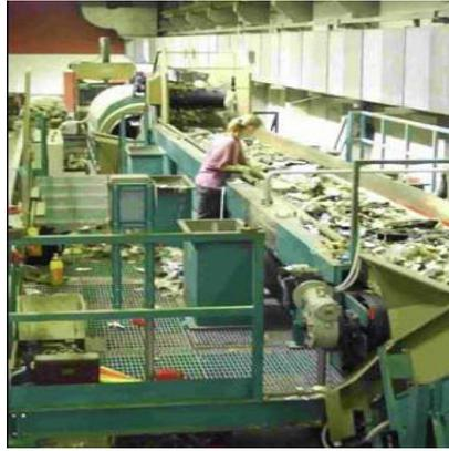
**Figura 2.8** Cinta de transportación para clasificación y separación<sup>8</sup>
