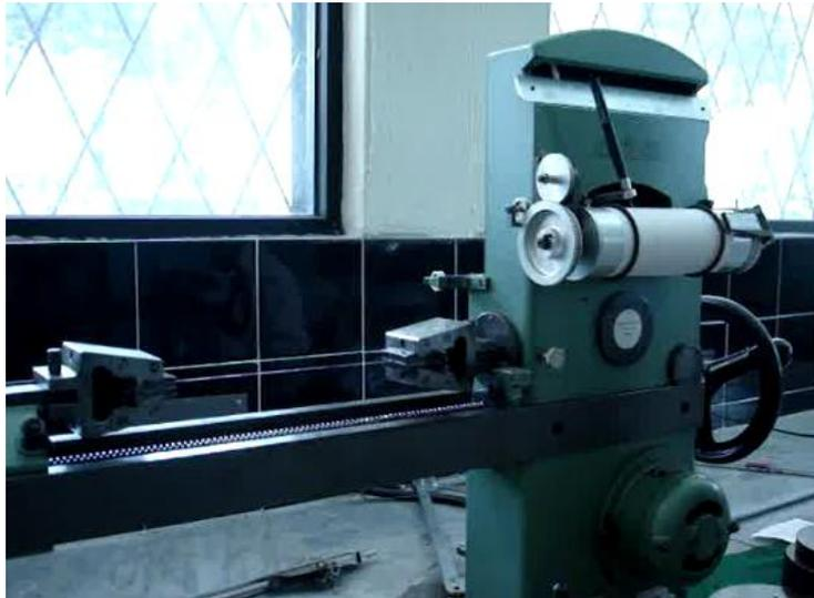
**Figura 6.13** Ejemplo de ensayo de tracción de fibra de RPET
