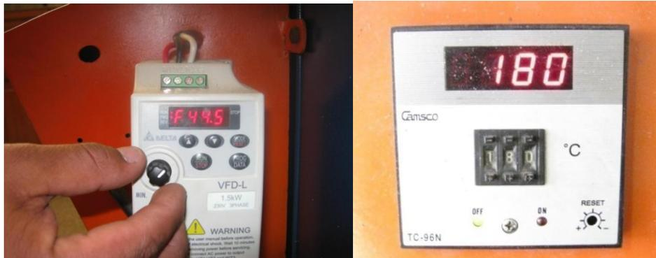
**Figura 6.3** Variador de frecuencia extrusora y control análogo de temperatura respectivamente
