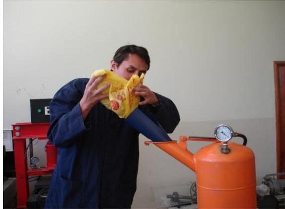
**Figura 6.4** Colocación de RPET en la boquilla de alimentación de la desgasificadora
