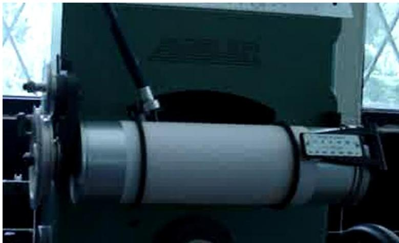
*Figura 6.10 Papel milimetrado montado en la máquina de ensayos AMSLER*
