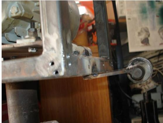
Montaje de polea tensora
