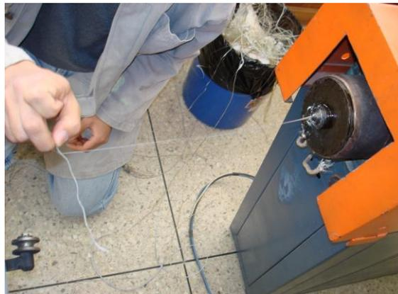
**Figura 6.5** Material continuo y estable producido por la extrusora
