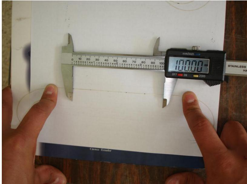
**Figura 6.8** Muestra de fibra para prueba de tracción
