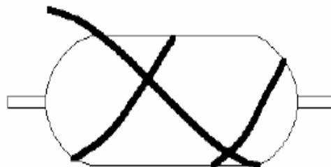
**Figura 3.5** Bobinado helicoidal con un ángulo de bobinado pequeño.
