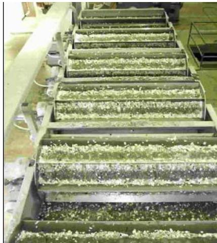
**Figura 2.9** Tambores con paletas para flotación de poliolefinas.<sup>9</sup>
