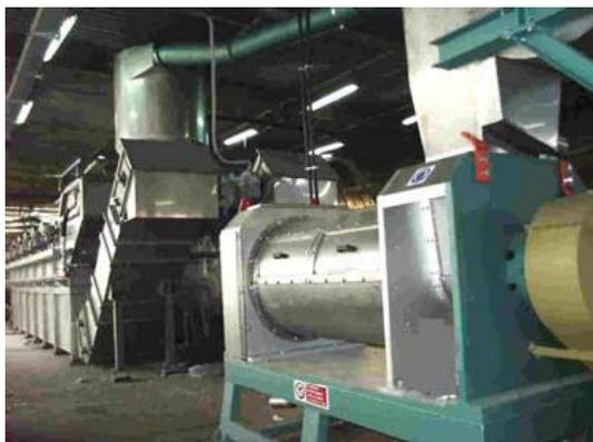
**Figura 2.11** Línea de lavado secado centrifugado<sup>11</sup>
