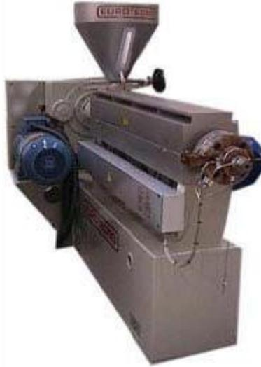
**Figura 2.12** Extrusores para PET<sup>12</sup>
