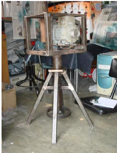
Base y soporte ensamblados de la máquina bobinadora
