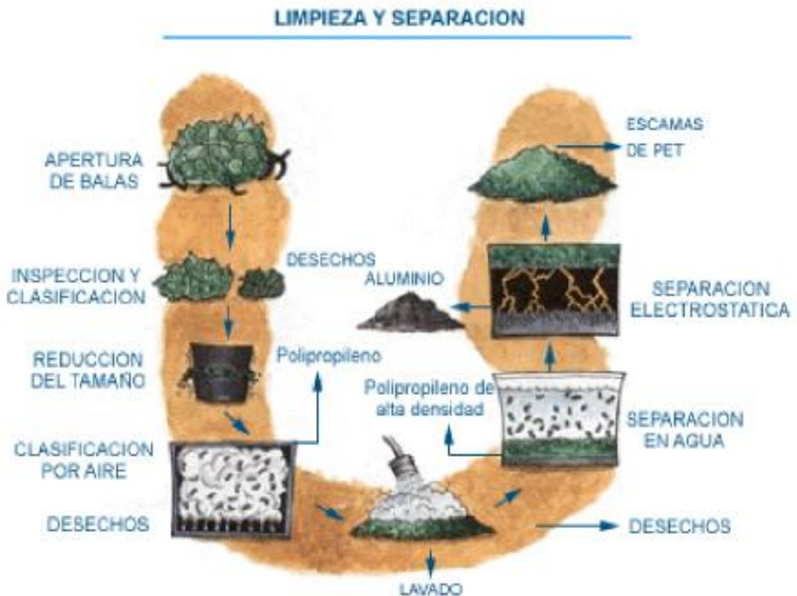
**Figura 2.1** Limpieza y separación de plásticos<sup>1</sup>
