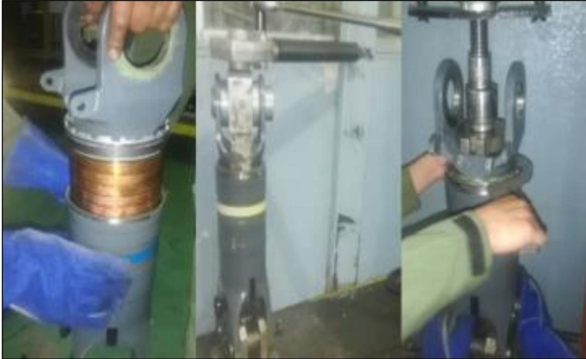
Se colocó el muñón en el útil de sujeción muñón
