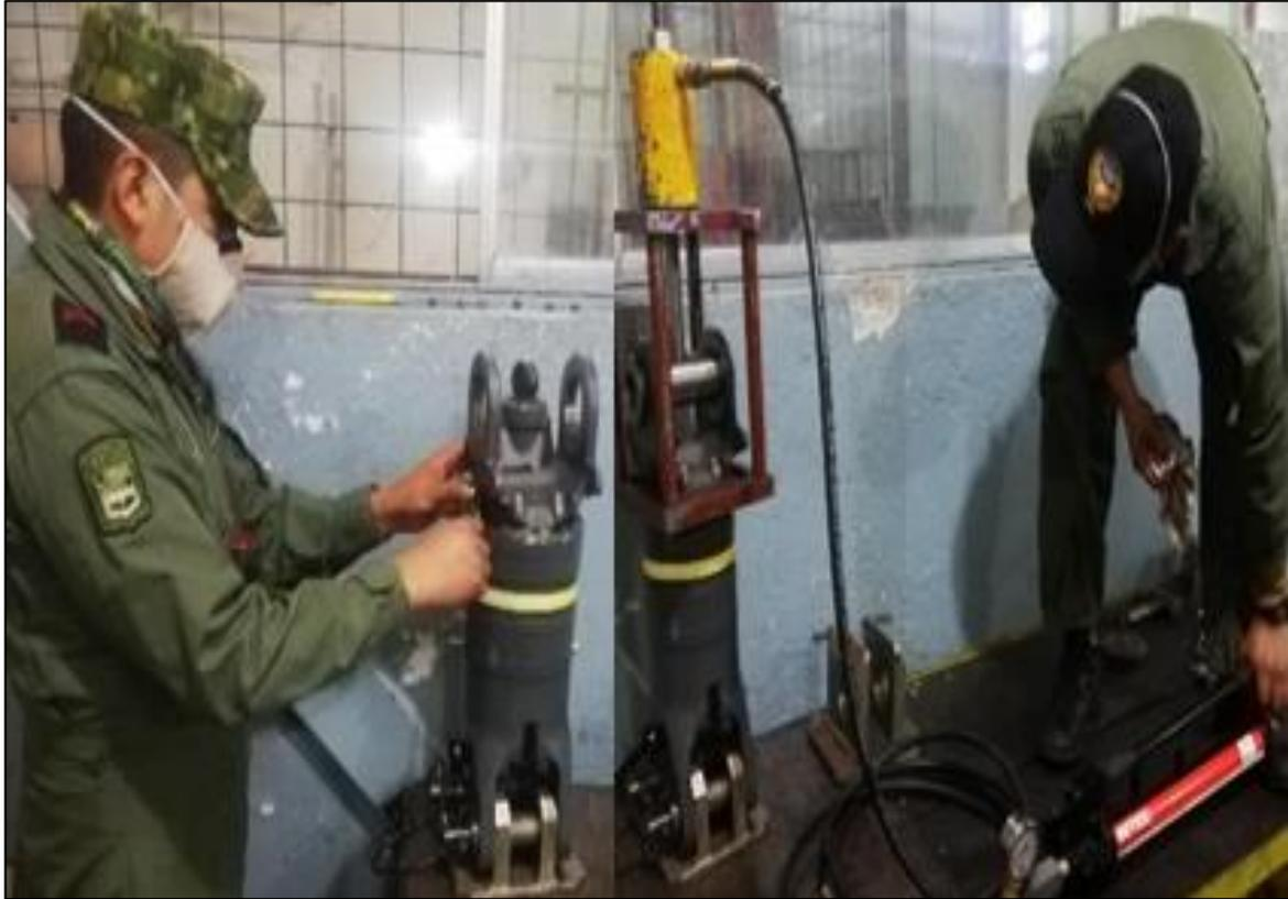
Se colocó el tapón magnético equipado con la junta
