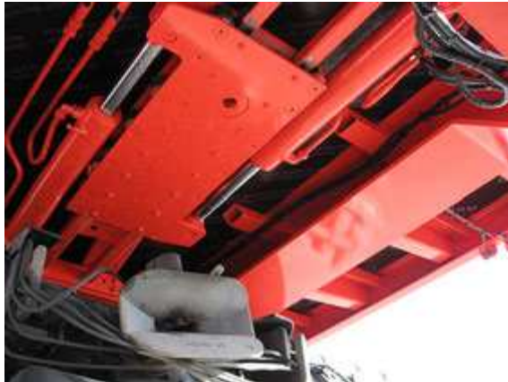
Grafico 2.7 Circuito de dirección de Plataforma Extensible
