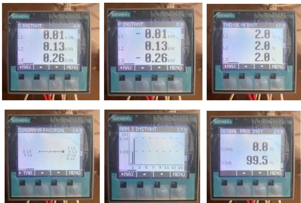
*Nota.* La figura muestra las diferentes mediciones que puede realizar el equipo SENTRON PAC4200 mismas que se pueden utilizar para diferentes problemas presentados en la red.
