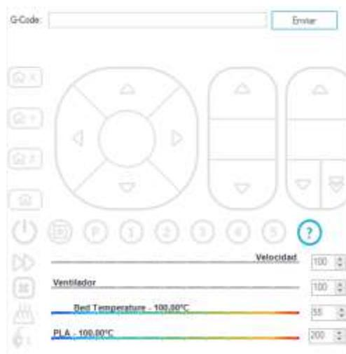
Se puede controlar el calentamiento del extrusor de manera segura, siempre con la verificación visual de que se encuentra en una posición que no compromete la integridad de algún componente de la máquina.
