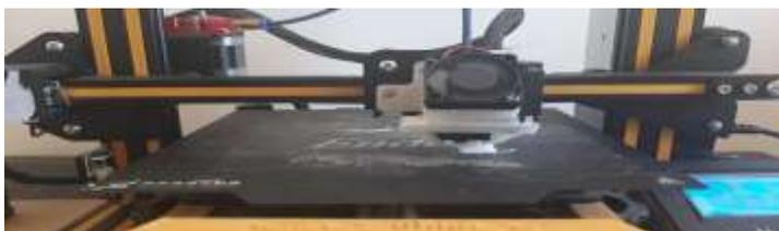
Una vez colocados los rodamientos lineales se prueba el juego de los ejes lisos para mantener una holgura precisa que no afecte en su movimiento.
