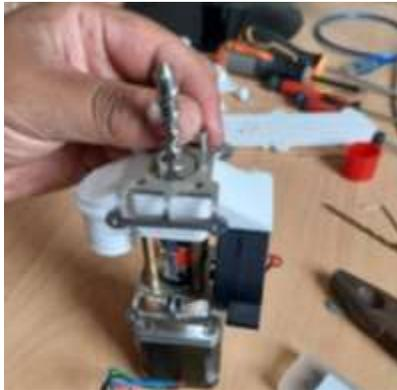
Se coloca la boquilla de donde sale el material junto con su respectivo sensor de temperatura y la niquelina que calentara el entorno.
