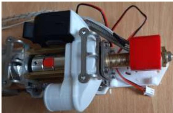
Ya hecho el montaje, queda poner los ventiladores cooler fan de 12V que controlan la temperatura de la boquilla para un control eficiente del calentamiento del extrusor.
