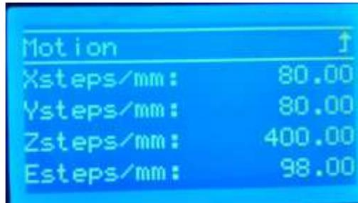
Figura 54 Pasos por milímetro de todos los ejes mostrados en la pantalla LCD
