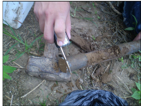
Foto 38. Extracción de muestra del suelo.
