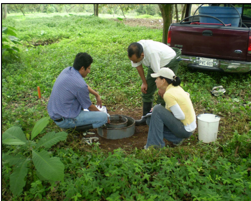
Foto 9. Prueba de velocidad de infiltración.
