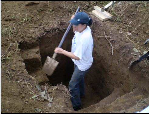
Foto 5. Construcción de la calicata 1
