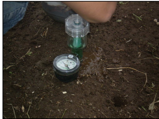
Foto 36. Instalación de los tensiómetros.
