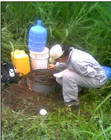
Foto 15. Prueba de velocidad de infiltración.
