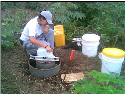
Foto 21. Prueba de velocidad de infiltración.
