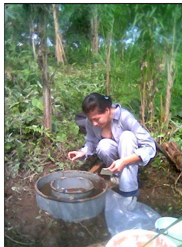
Foto 28. Prueba de velocidad de infiltración.
