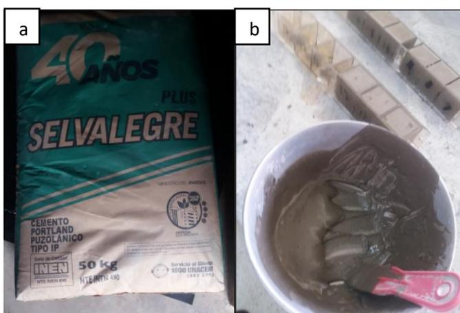
*Nota.* a) Cemento Selva Alegre. b) Mezcla del cemento y moldes cúbicos
