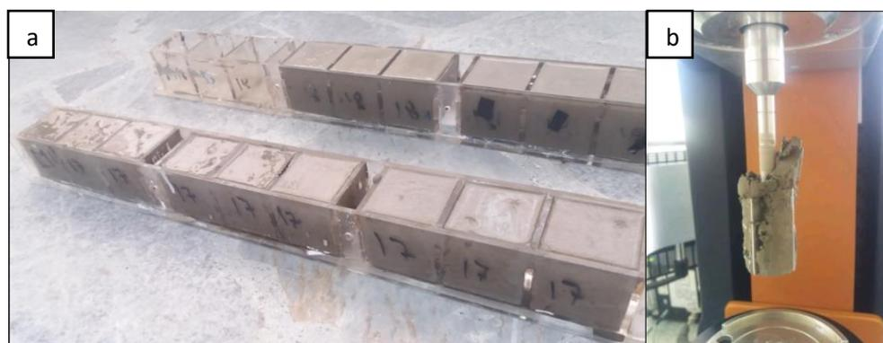
*Nota.* a) Mezcla de B, S, R y P con cemento al 2% en moldes cúbicos. b) Tratamiento con S2,5% en la hélice del reómetro.
