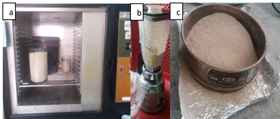
*Nota.* a) Secado en la estufa. b) Trituración en la licuadora. c) Tamiz de 300 micrómetros.
