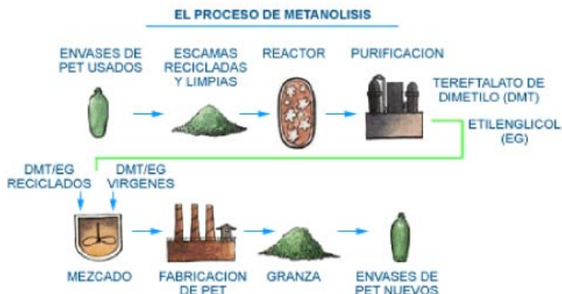
Fig. 2.10 Reciclado químico de envases PET
