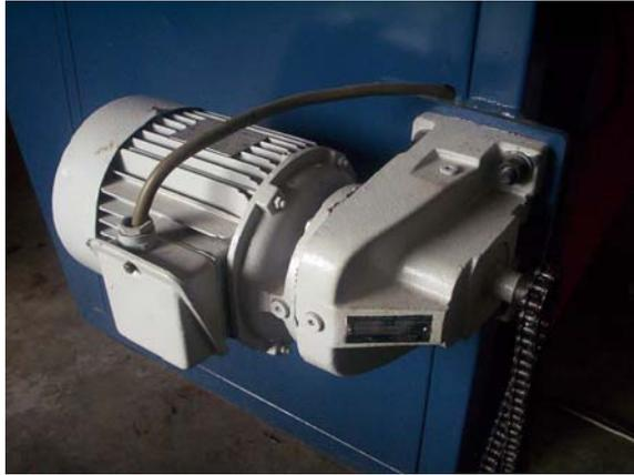
Fig. 4.40 Motorreductor
