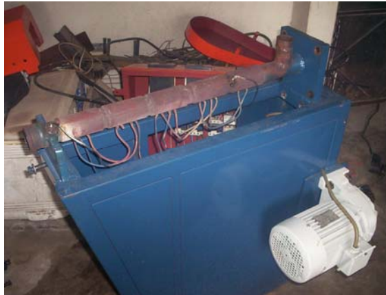
Fig. 5.6 Estructura soporte, camisa y motorreductor
