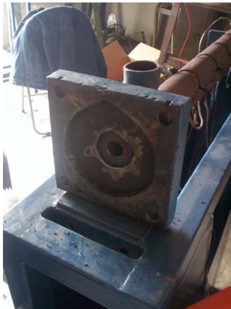
Fig. 5.8 Placa soporte ensamblada a la camisa
