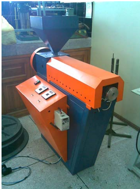
Fig. 5.21 Extrusora completamente ensamblada
