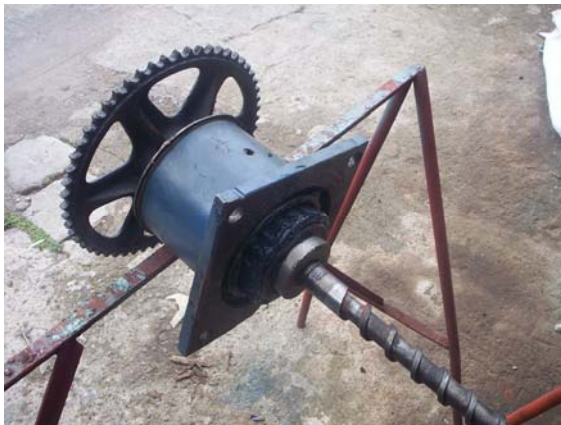
Fig. 5.11 Rueda montada sobre el eje motriz. Rodamiento cónico y tornillo
