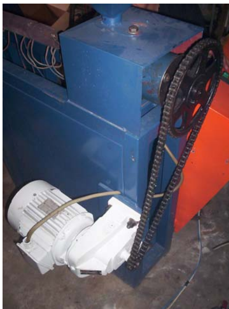
Fig. 5.12 Sistema de transmisión de potencia completamente montado
