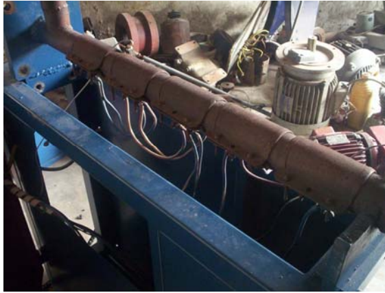
Fig. 5.9 Placas frontal y trasera de soporte soldadas a la camisa
