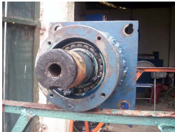
Fig. 5.10 Eje motriz y cilindro de alojamiento para los rodamientos
