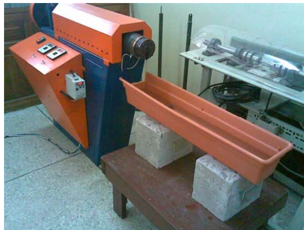
Fig. 6.5 Cabezal de extrusión en funcionamiento
