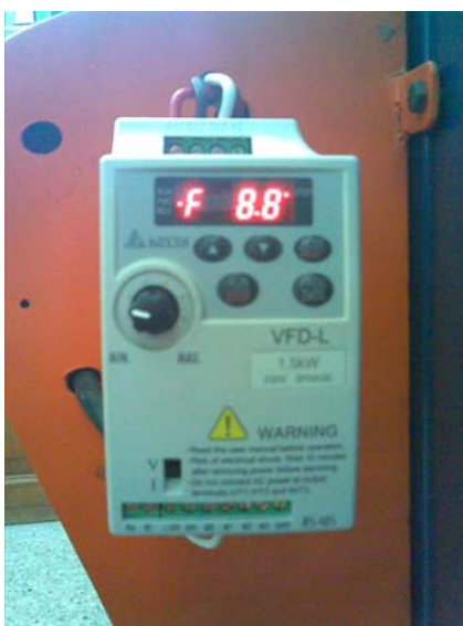
Fig. 6.4 Variador de frecuencia
