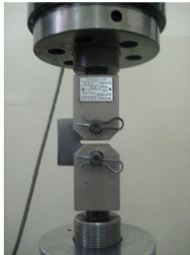
**Figura 3.10 Montaje de la Probeta CT ASTM E399**
