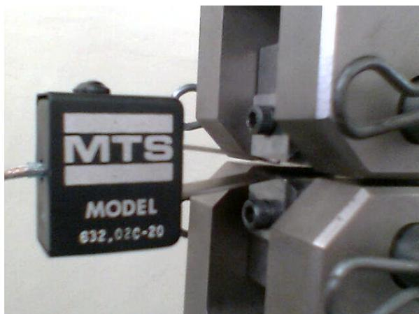
**Figura 3.14 Ensamble del extensómetro**
