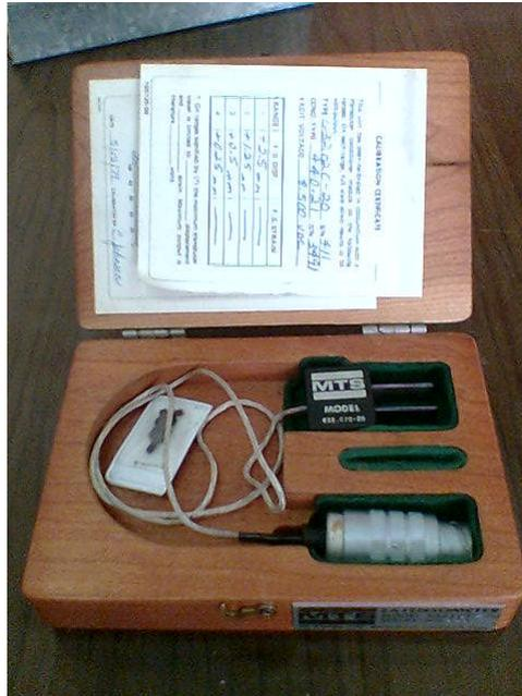
**Figura 3.4 Galga de desplazamiento CLIP-ON GAGE Modelo 632.02C-20**
