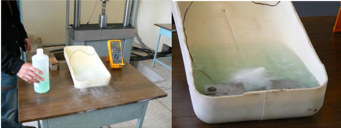
**Figura 3.17 Disminución de temperatura de las probetas.**
