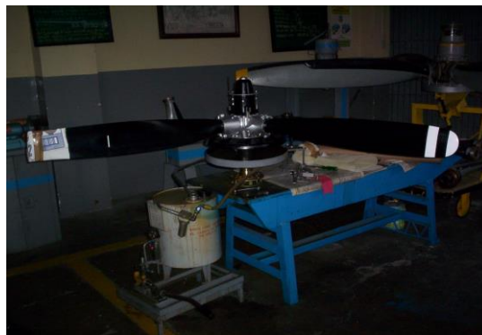
Figura 1.18. Hélice en posición de bandera
