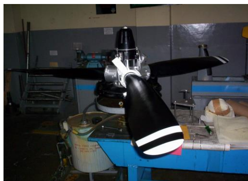
Figura 1.20. Hélice en paso alto
