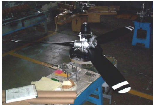
Figura 1.19. Hélice en paso bajo
