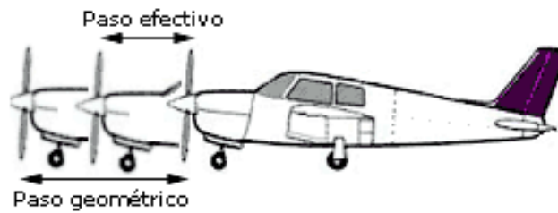
Figura 1.13. Paso efectivo y paso geométrico
