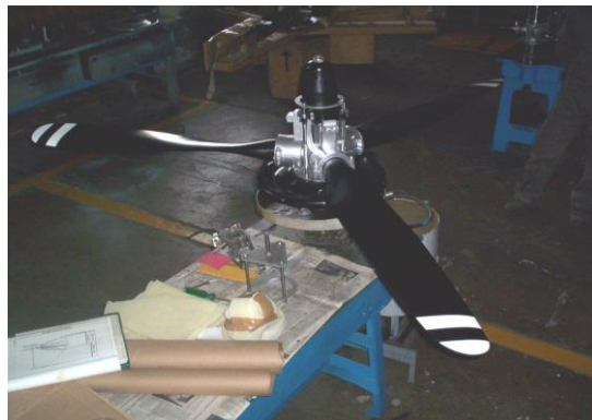
Figura 1.21. Hélice en posición de reversa
