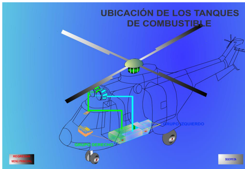
Fig. 4.4 Ubicación de los Tanques de Combustible.
