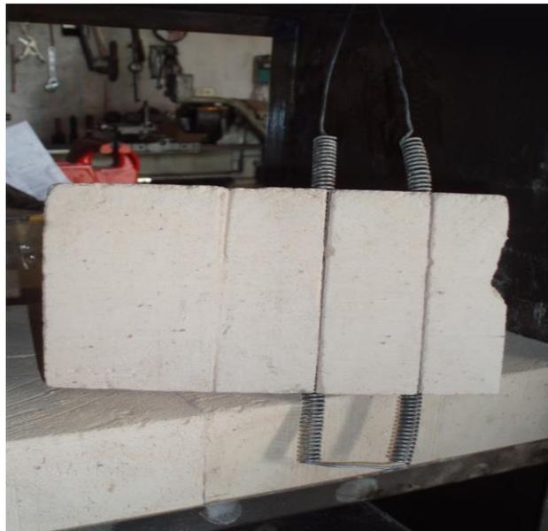
**Figura 4.4 Instalación de las resistencias**
