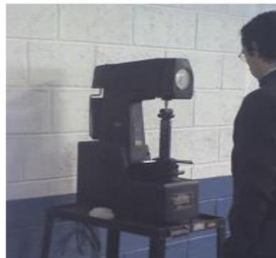
**Figura 4.7 Durómetro**
