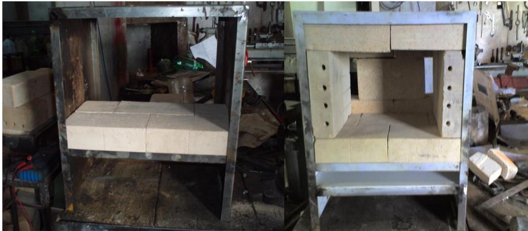
**Figura 4.3 Construcción cámara interna**
