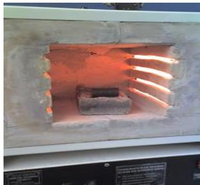
**Figura 4.6 calentamiento probeta**
