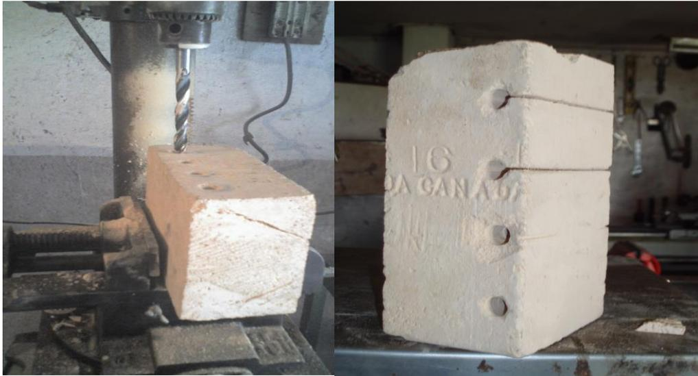
**Figura 4.2. Preparación de ladrillos refractarios**
