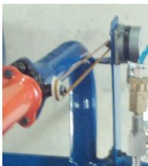
**Fig.9 Sistema de activación de la Válvula Bypass**
