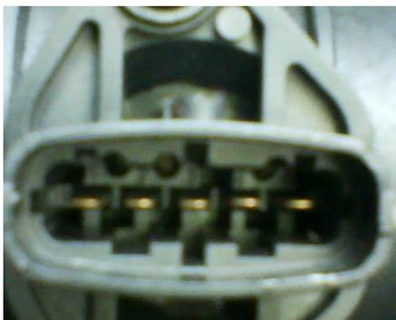
Figura 4.21. Conector del sensor MAF
