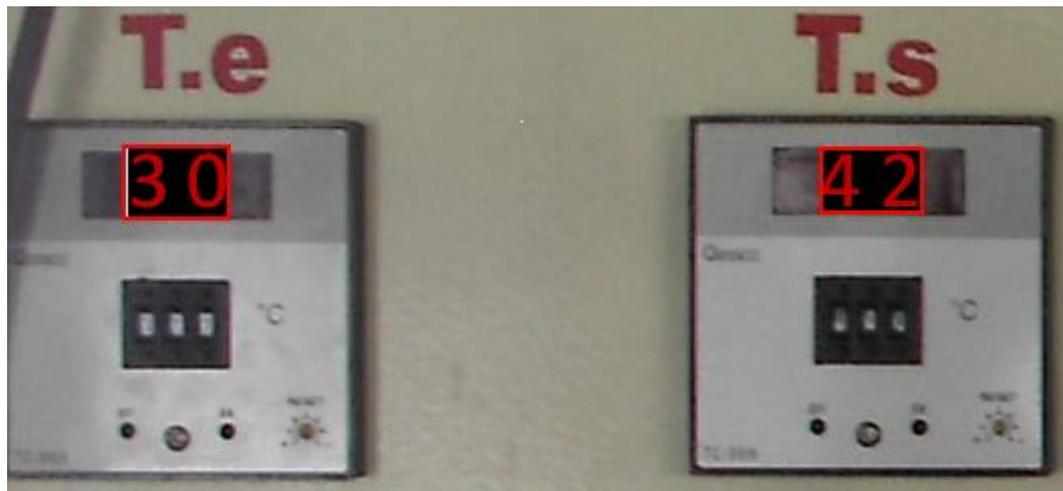
Figura 3.18. Temperatura de ingreso al turbocompresor y salida al enfriador al alcanzar la temperatura ideal de trabajo de 82°C el motor Isuzu
