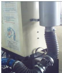
**Fig.6 Localización del Sensor MAF**
