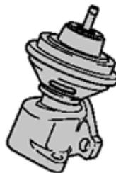
**Figura 4.8. Válvula EGR neumática**
