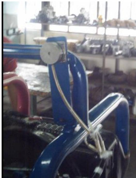
**Figura 5.11. Conexión del motor a pasos**
