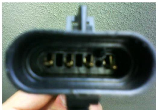
**Figura 4.20. Conector del sensor del oxígeno**
