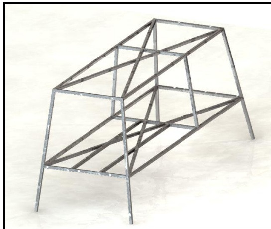
Figura 3.12.- Estructura de la bancada
