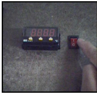
Figura 6.5.- Encendido del controlador
