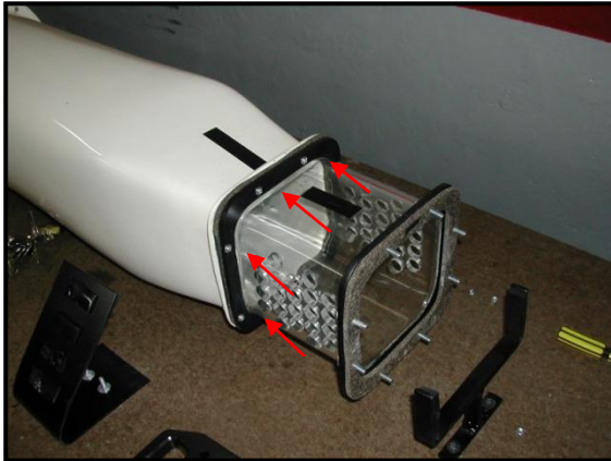
Figura 5.28.- Instalación zona de pruebas
