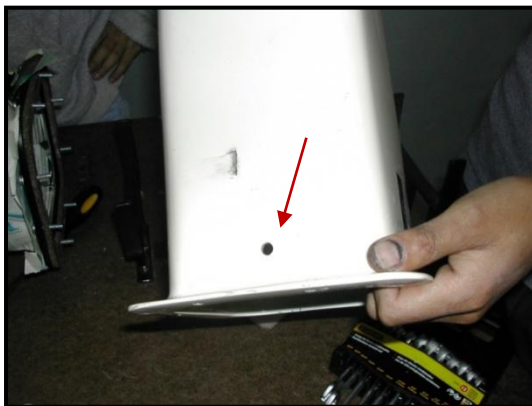
Figura 5.38.- Agujero túnel de ingreso
