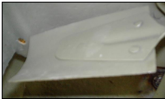
FIG. 3-3. Álabes con margen de dobles de 2^\circ
