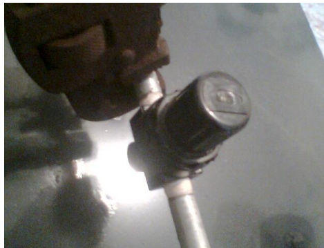
Figura 3.8 Ensamble de regulador de presión de aire.
