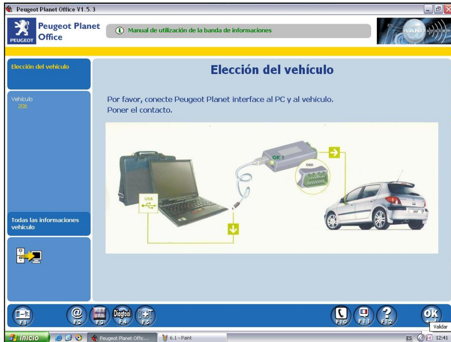
Figura 4.4. Conexión de scanner/interfaz
