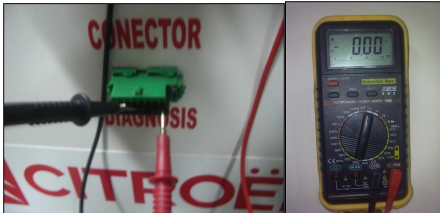
Figura 4.32.- Pin 4 del conector 16V NR de la toma de diagnosis.
