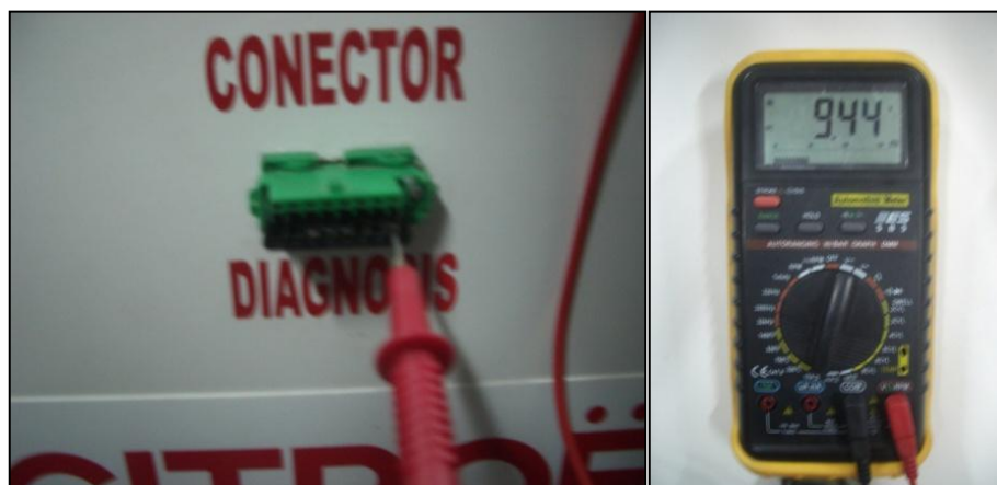
Figura 4.33.- Pin 11 del conector 16V NR de la toma de diagnosis.
