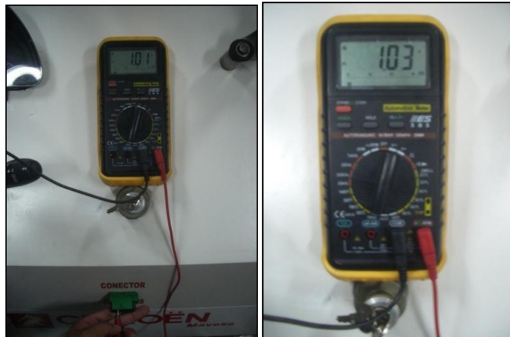
Figura 4.36.- Pin 6 del conector 16v NR de la toma de diagnosis.
