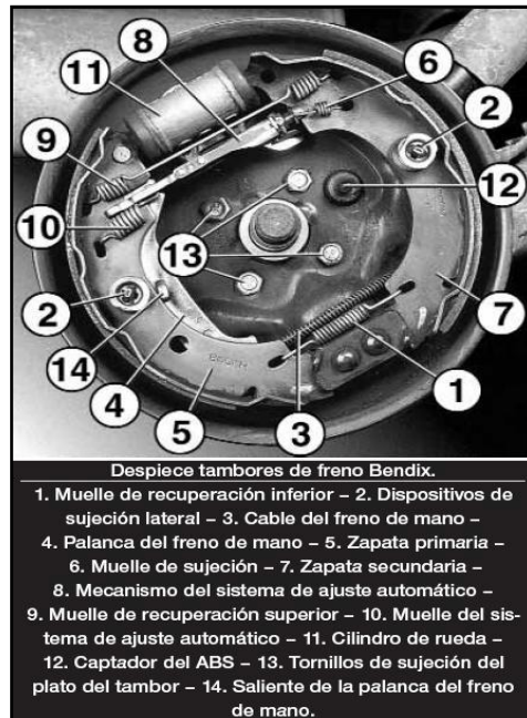
Fig. 4.24. Sistema Bendix
