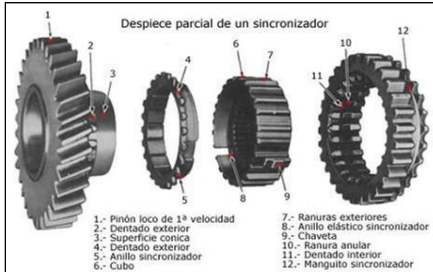
Fig. 2. 15. Despiece del sincronizador
