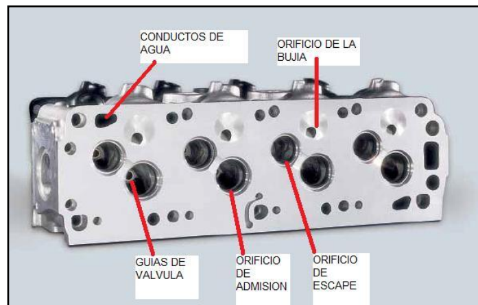
Fig. 1.52. Partes de La Culata
