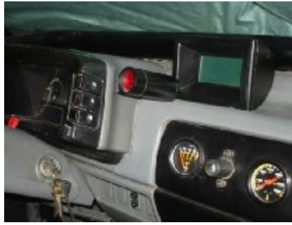
Figura 4.17. Instalación del tacómetro en el tablero
