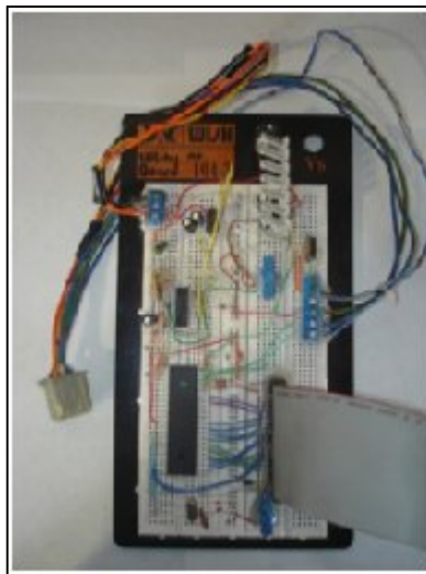
Figura 2.42. - Circuito de conexión del tacómetro
