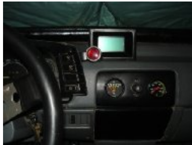
Figura 4.16. Instalación de Tacómetro (auto)
