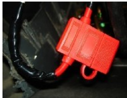
Figura 4.21. Instalación de alimentación y fusible
