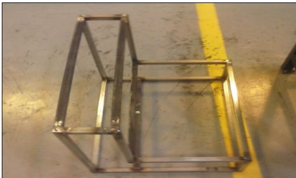
Figura 58. Estructura base terminada
