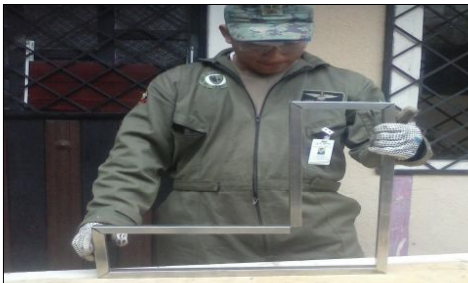
Figura 55. Armado de la base de los costados
