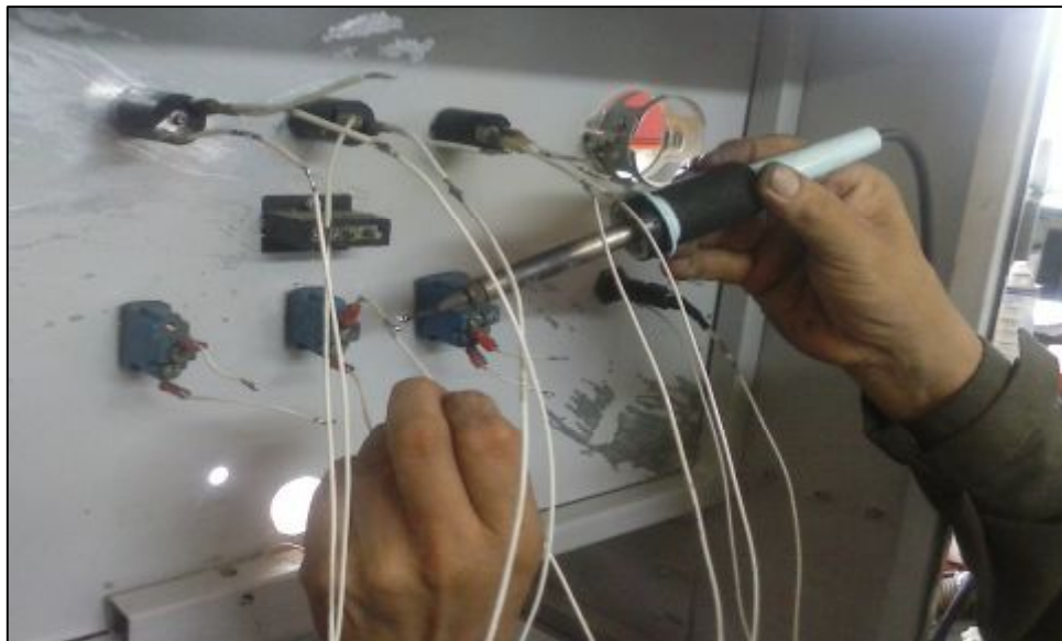
Figura 46. Suelda con cautín del cableado
