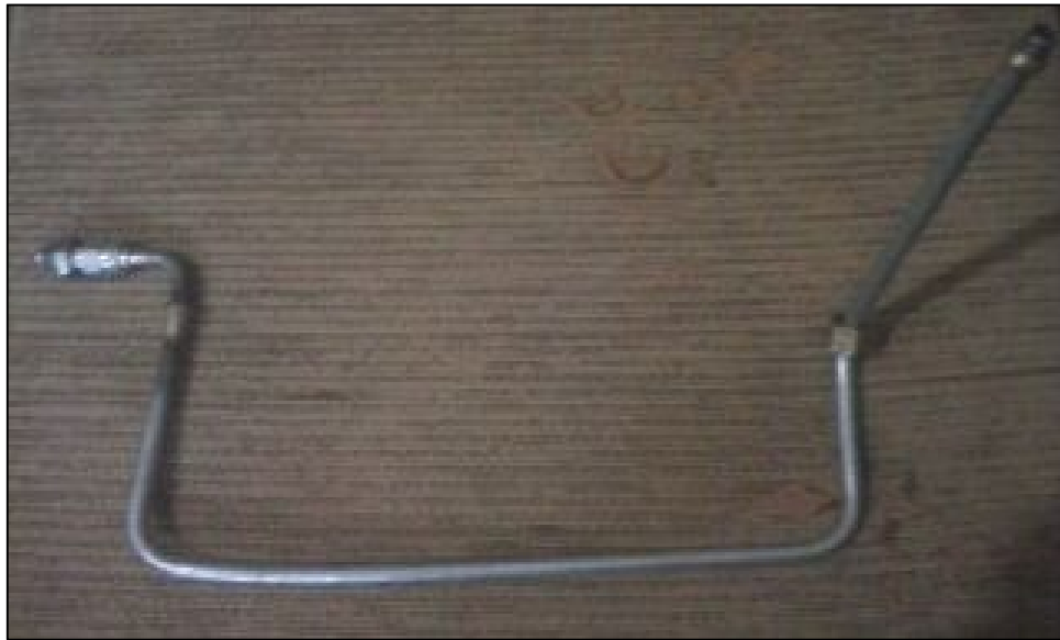
Figura 32. Cañería de conexión al transmisor de presión de torque
