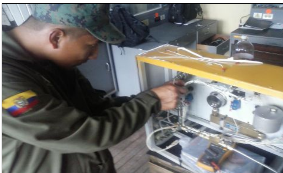
Figura 48. Amarre de conductores
