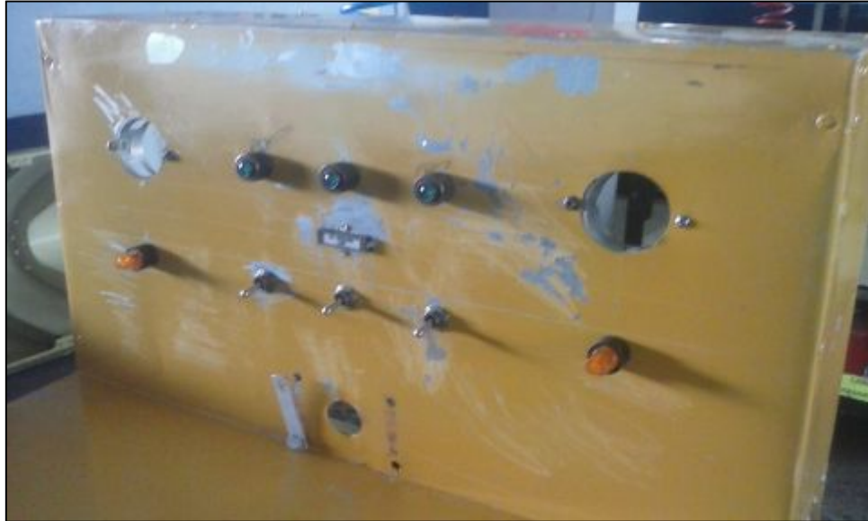
Figura 45. Instalación de luces, fusibles, interruptores y plugs (frente)
