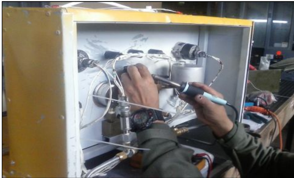
Figura 49. Verificación de fallas en suelda
