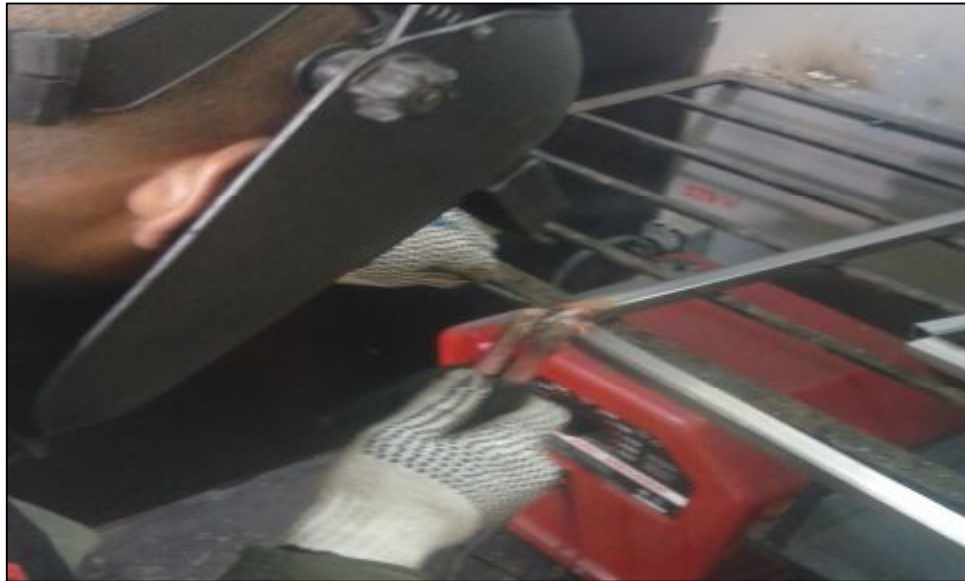
Figura 56. Unión de estructura mediante puntos de solda
