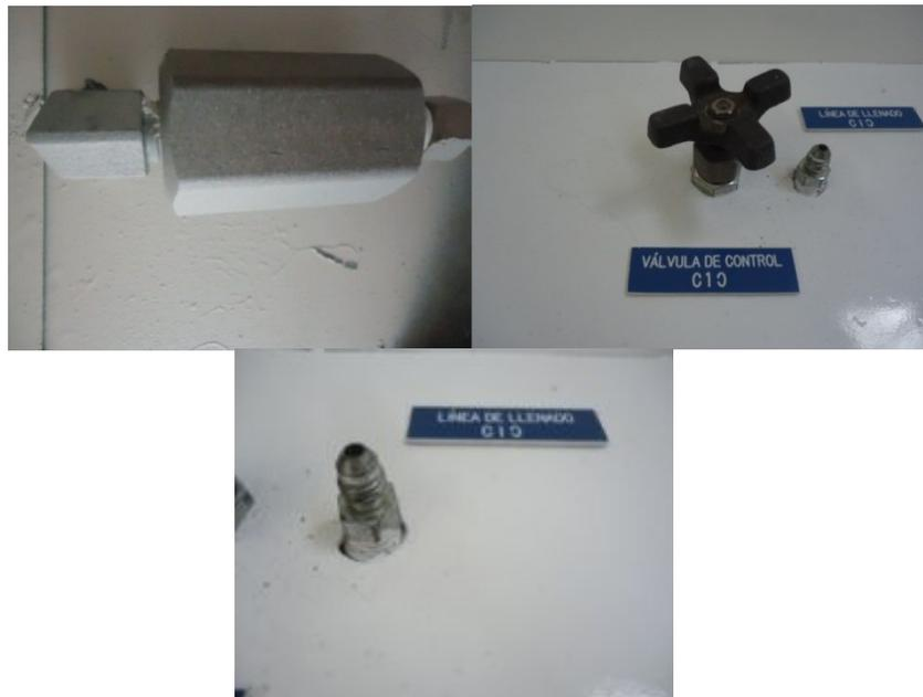
**Figura 62.** Instalación de las válvulas de aguja y línea de llenado
