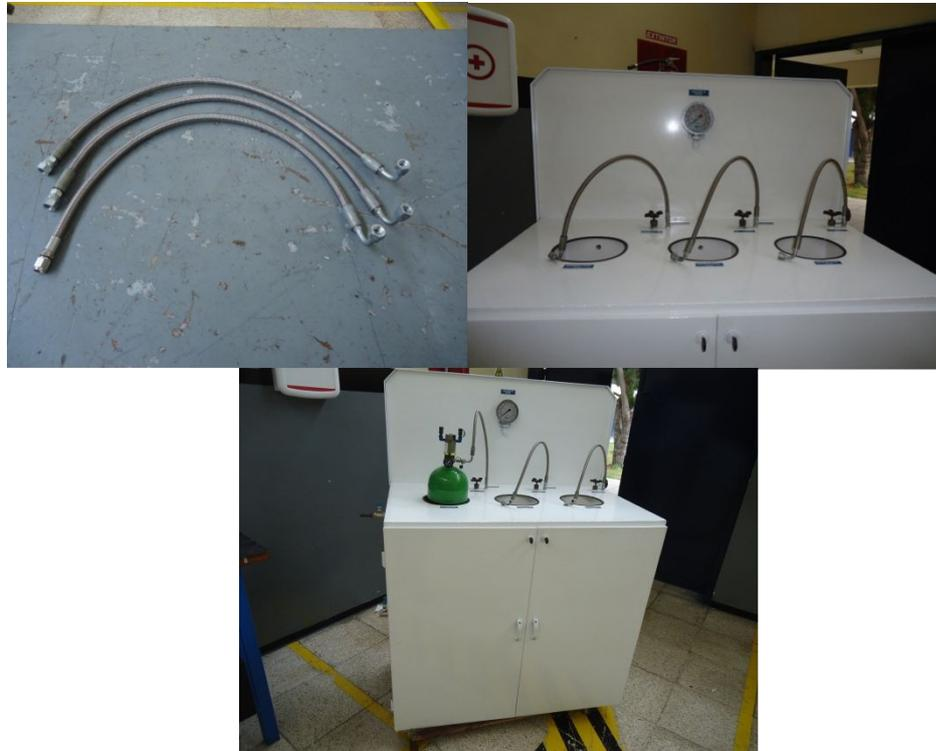
**Figura 70.** Instalación de las mangueras flexibles de las líneas de llenado
