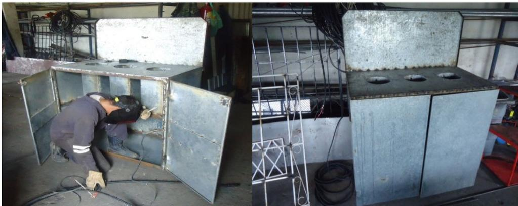
**Figura 54.** Ensamblaje de las puertas del banco
