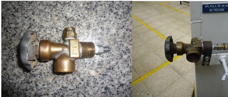
**Figura 65.** Instalación de la válvula de alivio de presión
