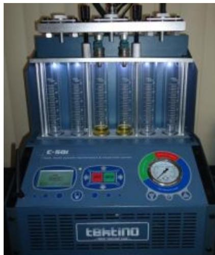
Figura18: Banco de comprobación limpieza de inyectores
