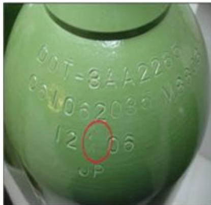
**Figura 24.** Logo de la fábrica que realiza la Prueba Hidrostática
