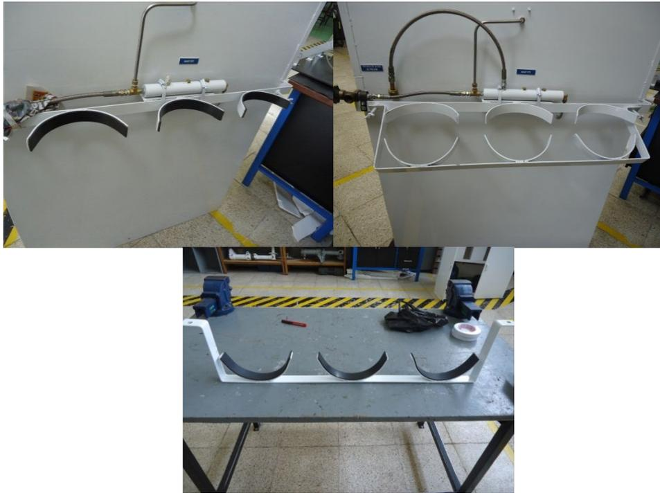
**Figura 71.** Instalación de cauchos en abrazadera de los cilindros
