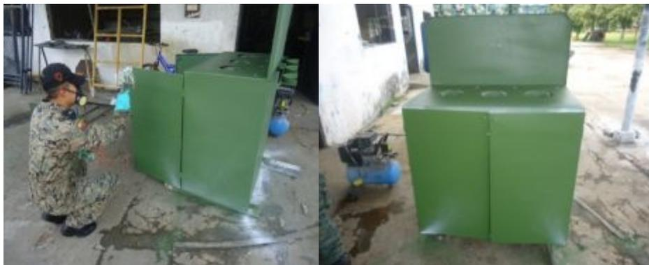
**Figura 60.** Pintado con pintura de fondo anticorrosivo
