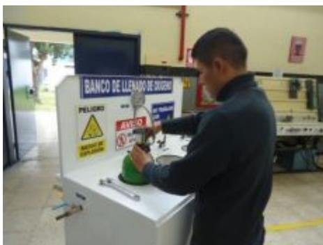
**Figura 73.** Prueba de funcionamiento del banco de llenado de O2
