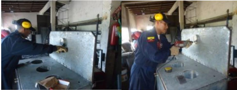
**Figura 59.** Orificios para la instalación del indicador de presión
