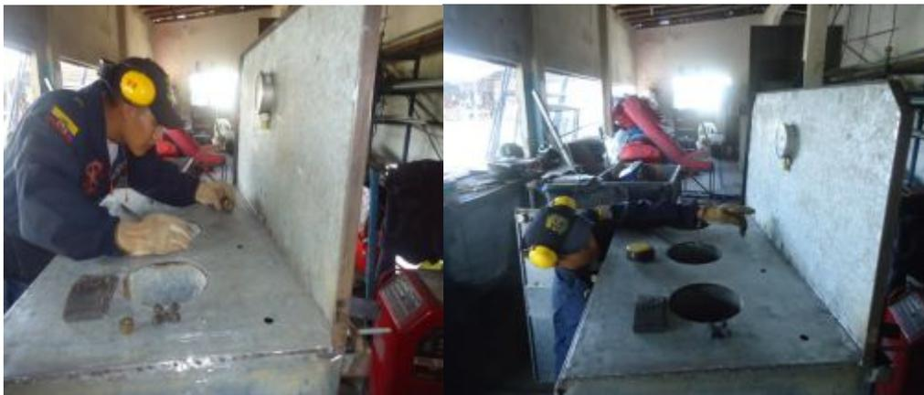
**Figura 58.** Verificación de las válvulas de aguja en el orificio
