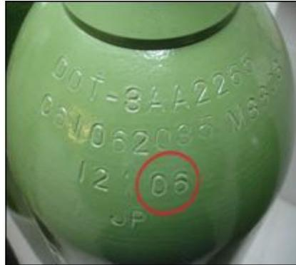
**Figura 23.** Última prueba Hidrostática
