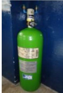
**Figura 5.** Cilindro de oxígeno del helicóptero Dhruv
