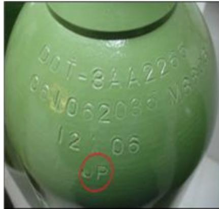
**Figura 25.** Inicial de quién realizó la prueba hidrostática
