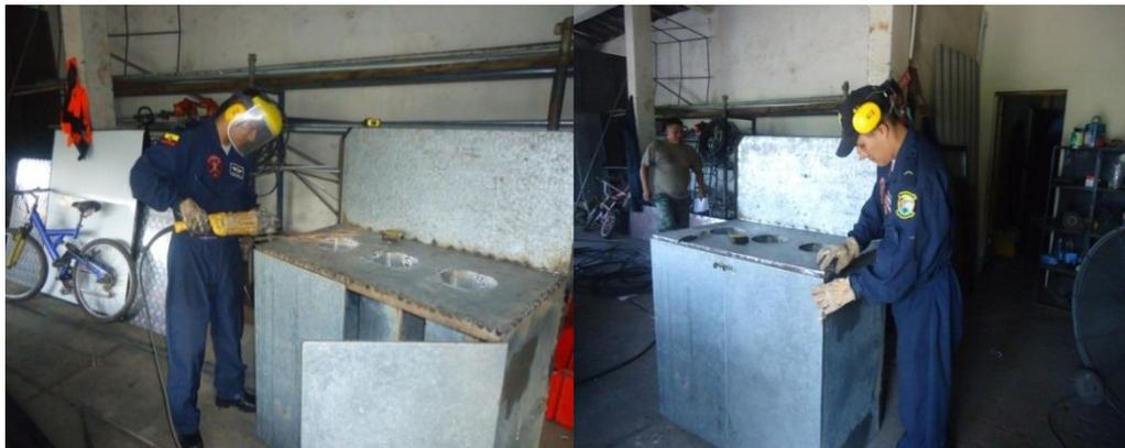
**Figura 56.** Pulimiento de las partes soldadas del banco.
