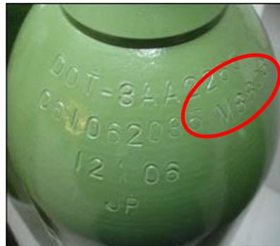
**Figura 19.** Presión del cilindro
