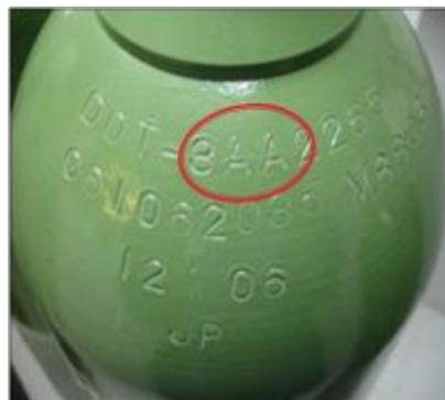
**Figura 20.** Material del cilindro
