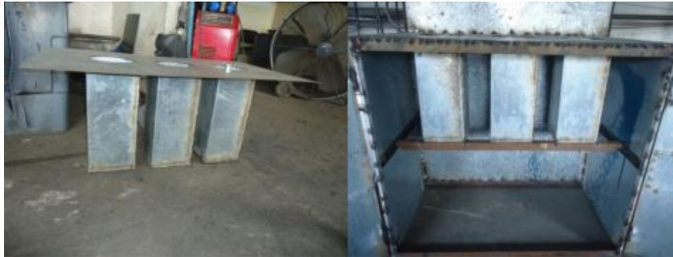
**Figura 53.** Ensamblaje de la sección de las botellas de oxígeno.
