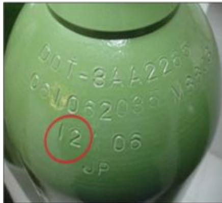
**Figura 26.** Mes cuando se realizó la prueba hidrostática
