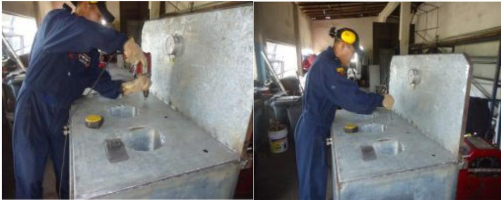
**Figura 57.** Orificios para válvulas de aguja y línea de llenado
