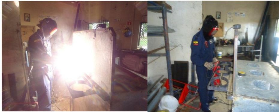
**Figura 55.** Ensamblaje de la abrazadera de los tanques de O<sub>2</sub>
