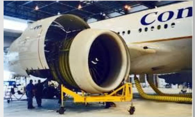
La plataforma móvil se apoya en tres conjuntos de rueda. Cada brazo ofrece un soporte con su respectiva amortiguación para el descanso del inlet cowl.
