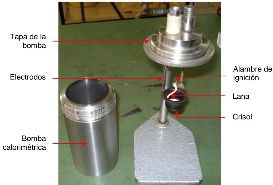
**Figura 3.7** Bomba de calor
