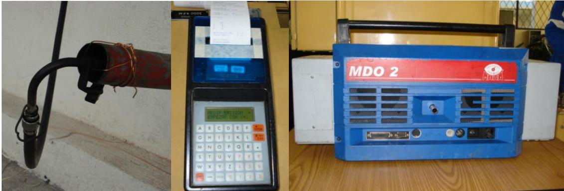
**Figura 3.11** Medición del porcentaje de opacidad (Opacómetro del CCICEV)
