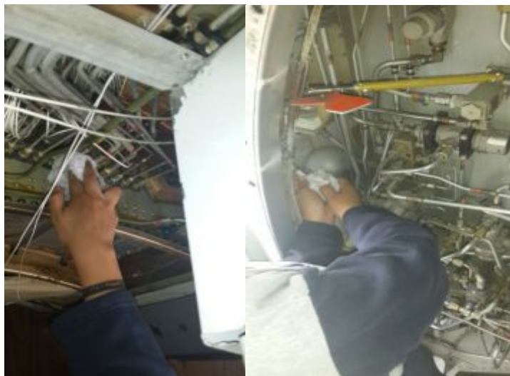
Figura 25: Limpieza sistema en cabina
