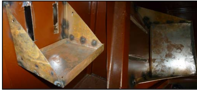
Figura 60. Construcción del soporte para el medidor de flujo
