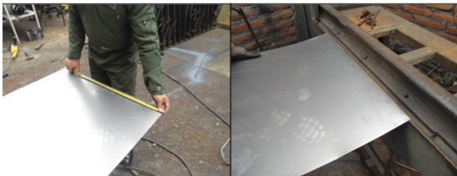
Figura 57. Medida, corte y suelda de la lámina de la estructura
