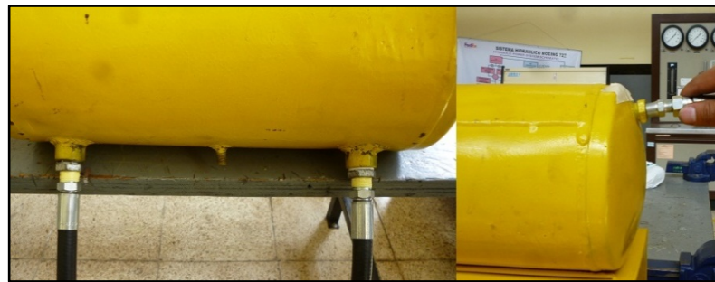
Figura 79. Conexión de las mangueras al tanque reservorio
