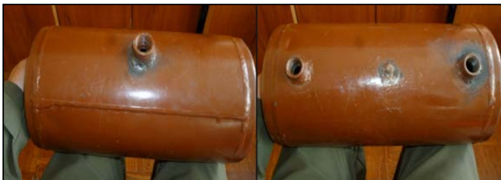
Figura 64. Acoples soldados al tanque reservorio
