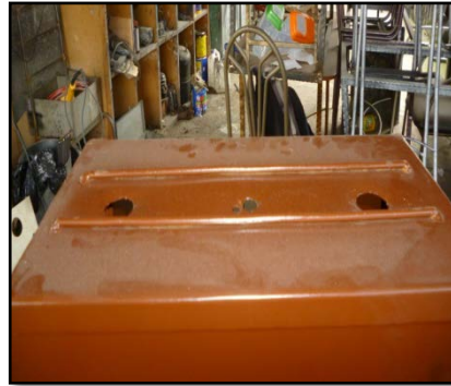
Figura 67. Construcción de orificios y varillas de fijación del tanque
