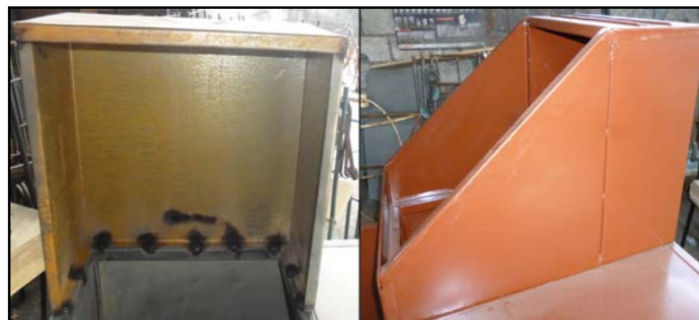
Figura 66. Estructura del tablero de control
