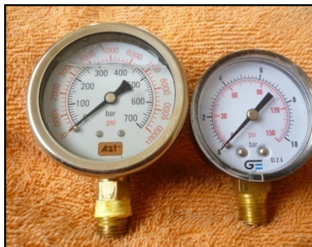
Figura 45. Manómetros de presión
