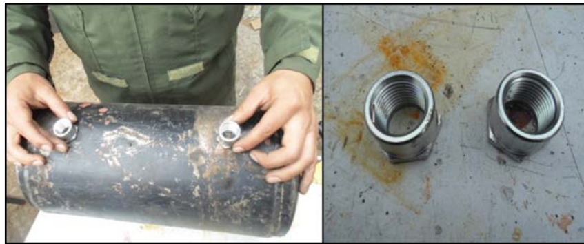
Figura 63. Tanque reservorio y acoples bushing
