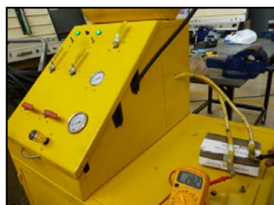
Figura 88. Indicación de 28V DC en los cables de conexión eléctrica
