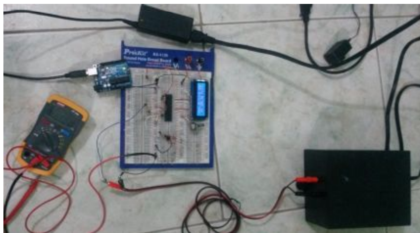
Figura 23 Prueba de ensayo del circuito de medición
