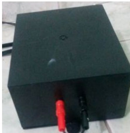
Figura 19 Fuente de poder de 28 VDC, 8 Amp.
