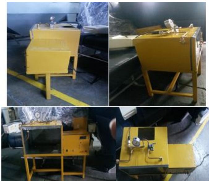
Figura 35 Sistema de comprobación de la Bomba Booster.
