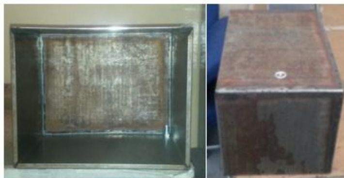
Figura 27 Reservorio de combustible de la Bomba Booster
