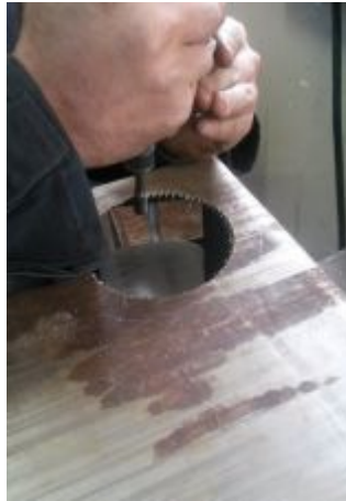
Figura 30 Limadura del orificio del reservorio
