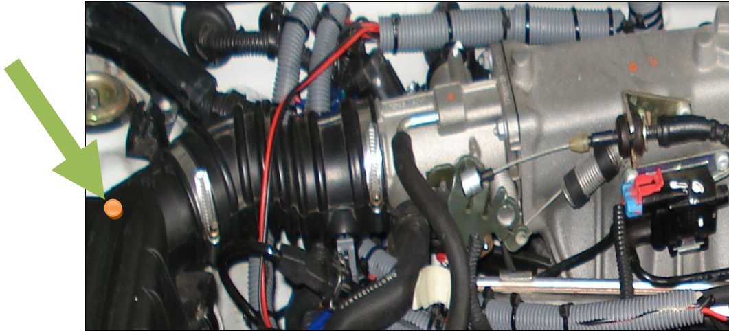
Figura 3.20 - Lugar de perforación para el inyector.
