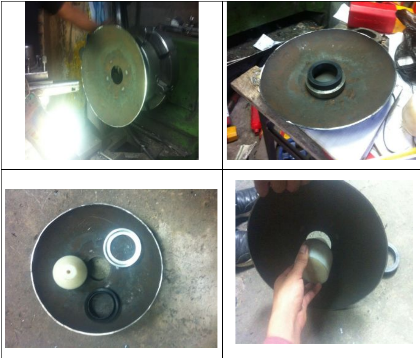
FIGURA 39: PROCESO DE INSTALACIÓN DEL DURALON
