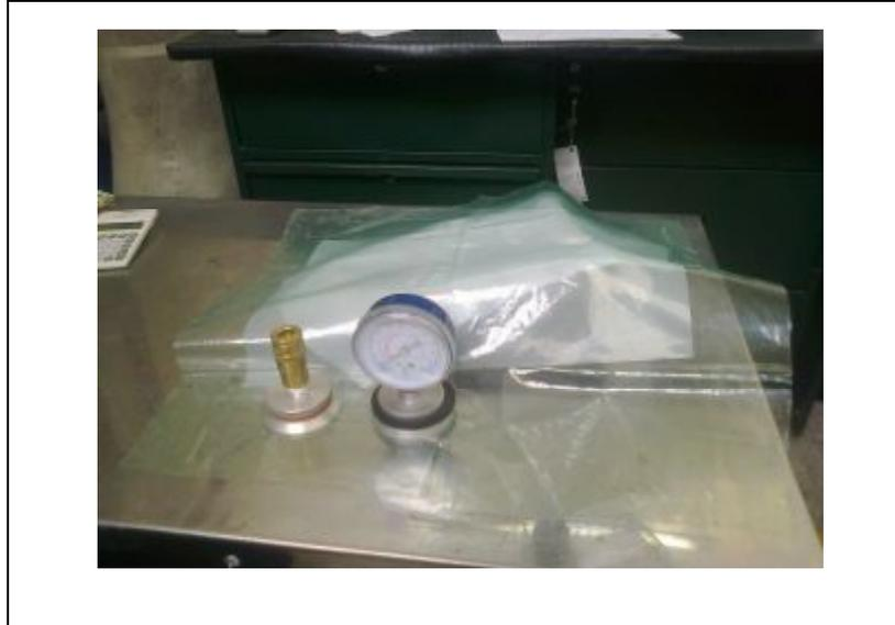
**Figura. 3.42** Ubicación de la toma de vacío y Vacuometro
