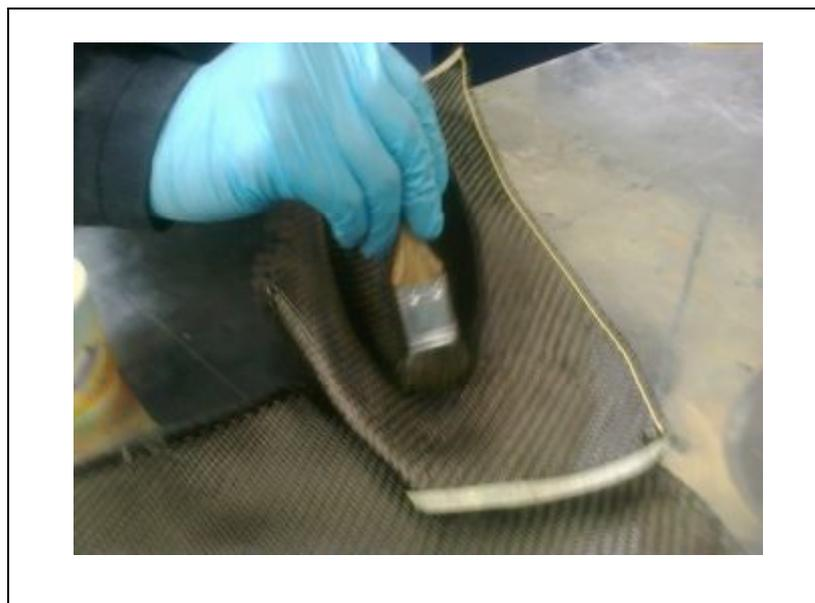
**Figura. 3.37** Aplicación de la primera capa de fibra de carbono
