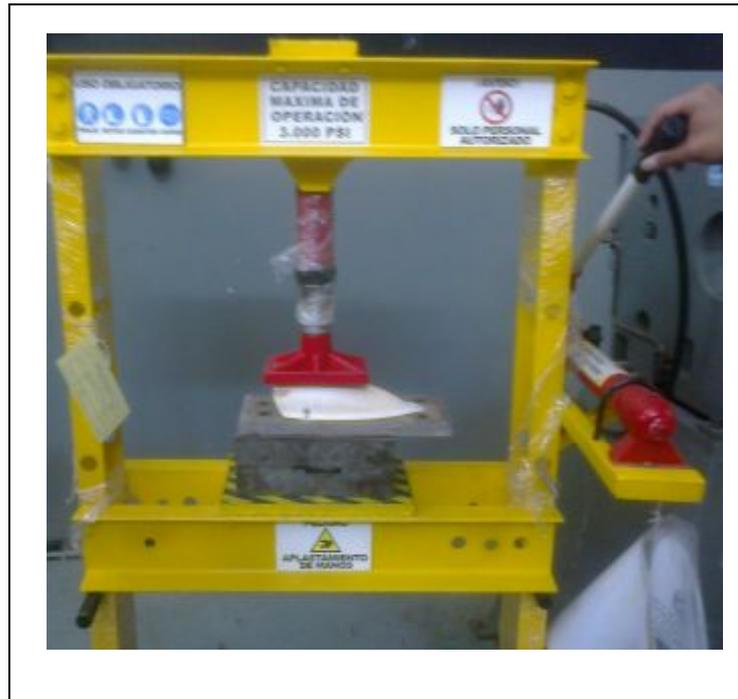
**Figura. 3.63** Compresión del Fairing de fibra de vidrio
