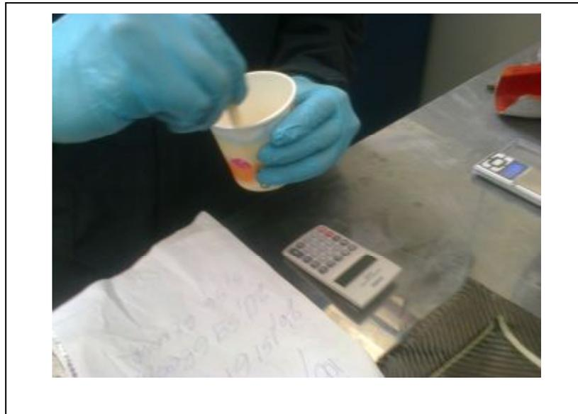
**Figura. 3.36** Mezcla de la resina preparada
