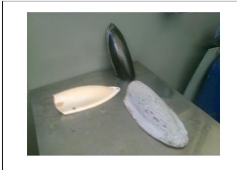
**Figura. 3.50** Fairing en fibra de carbono construido
