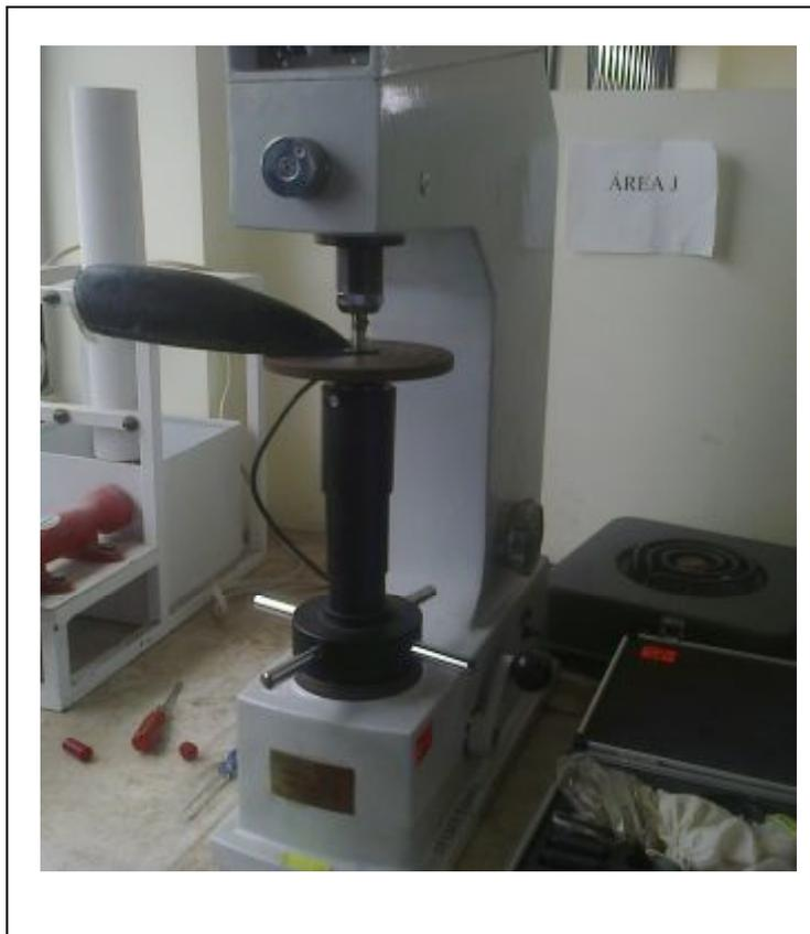
**Figura. 3.58** Ensayo Rockwell para fibra de carbono
