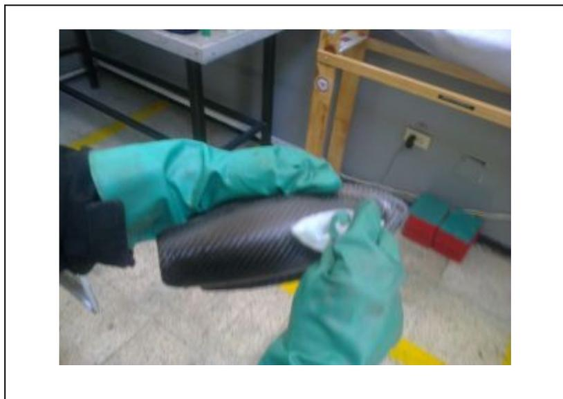
**Figura. 3.49** Limpieza con acetona del nuevo Fairing
