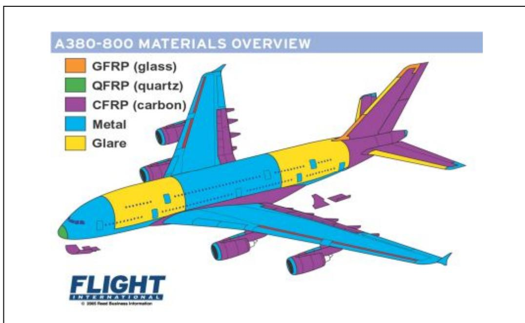
**Figura. 2.3** Componentes Estructurales del avión A380 – 800
