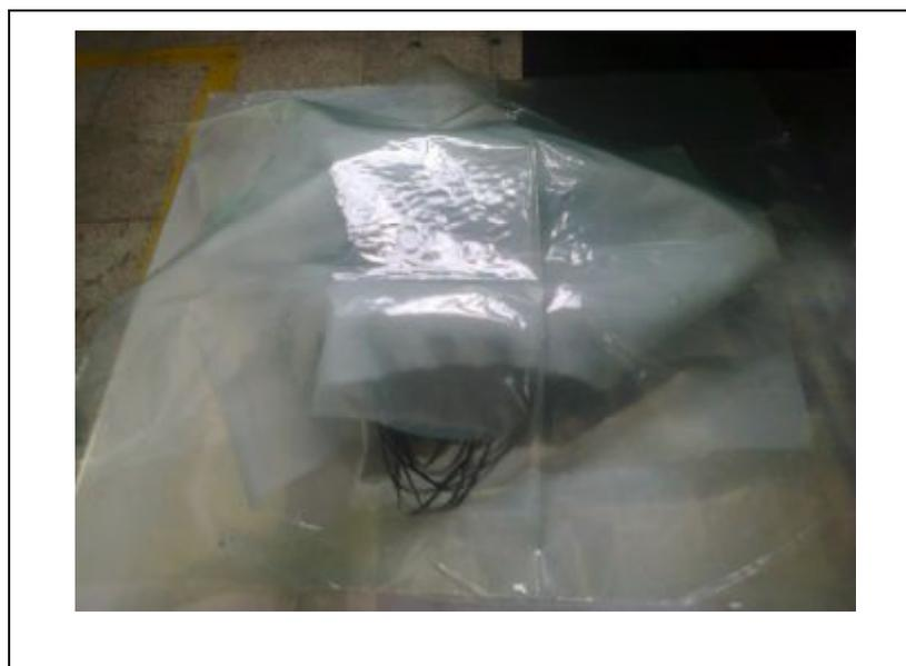
**Figura. 3.41** Aplicación del plástico perforable de vacío
