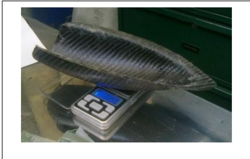
**Figura. 3.53** Medición del peso del Fairing de fibra de Carbono
