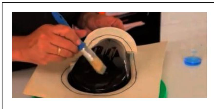
**Figura. 3.12** Aplicación del desmoldante PVA
