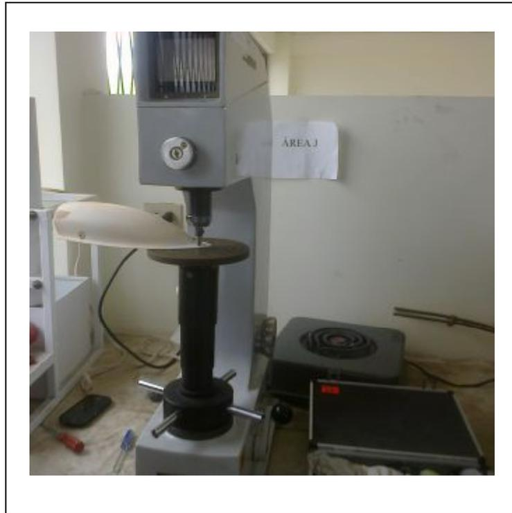
**Figura. 3.57** Ensayo Rockwell para fibra de vidrio
