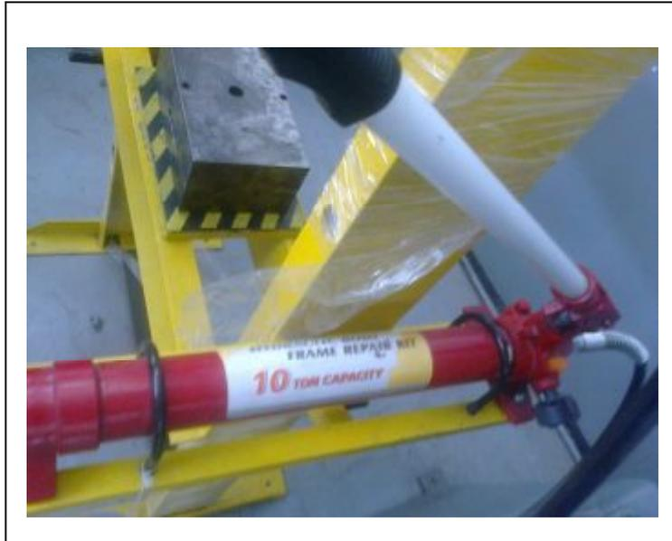
**Figura. 3.61** Cilindro neumático manual de prensa Hidráulica
