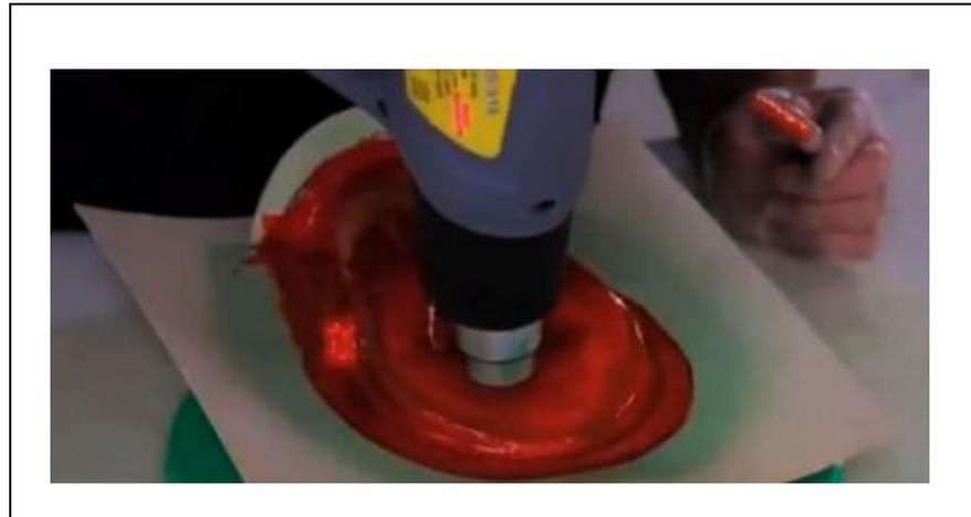
**Figura. 3.15** Secado del gelcoat
