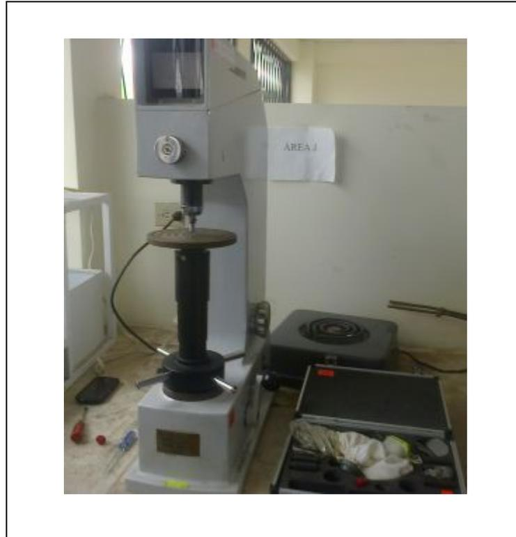
**Figura. 3.55** Máquina para realizar ensayos Rockwell
