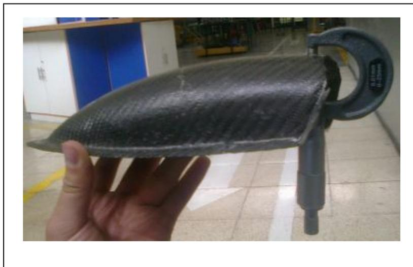
**Figura. 3.54** Medición del espesor del Fairing de fibra de Carbono
