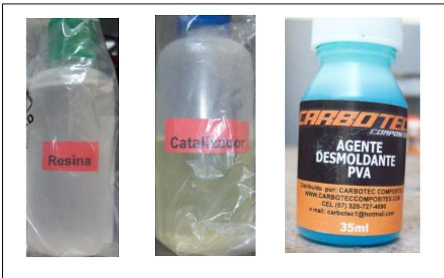
**Figura. 3.75** Kit de resina, catalizador, desmoldante PVA
