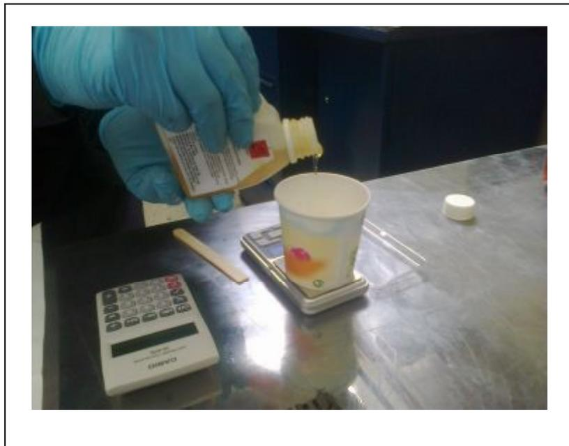
**Figura. 3.35** Aplicación del endurecedor
