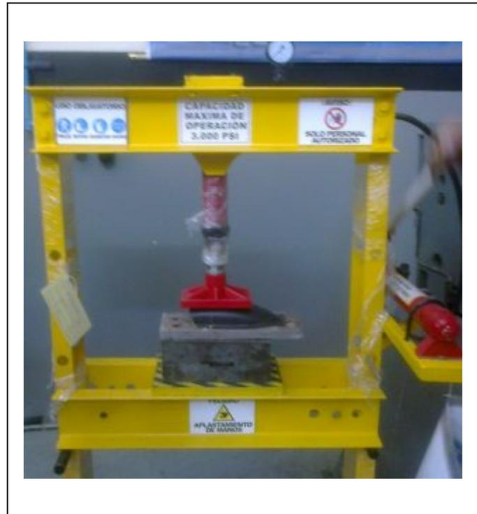
**Figura. 3.65** Compresión del Fairing de fibra de carbono
