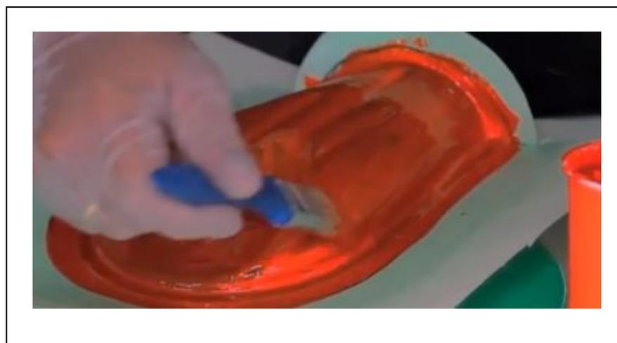
**Figura. 3.16** Segunda aplicación del gelcoat
