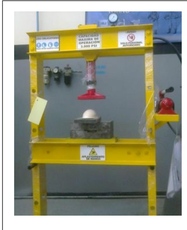
**Figura. 3.59** Prensa Hidráulica con capacidad de dos toneladas
