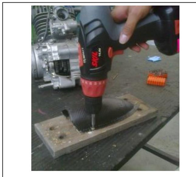
**Figura. 3.64** Empotrado en madera del Fairing fibra de carbono
