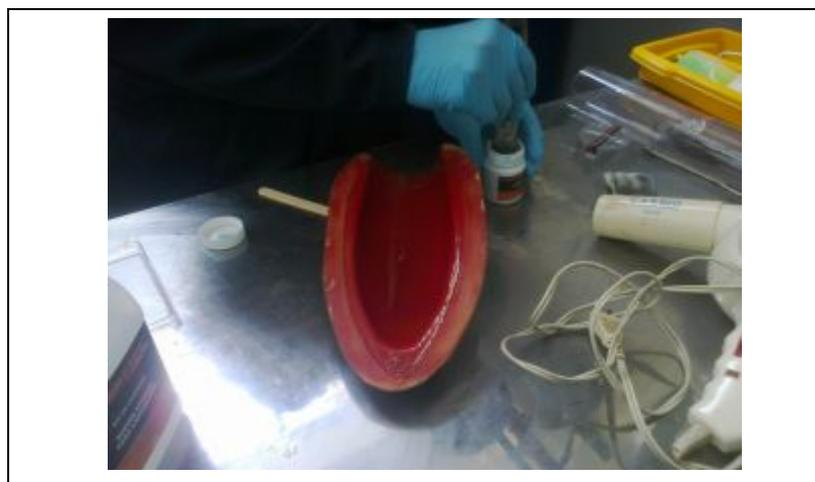
**Figura. 3.32** Aplicación del desmoldante PVA
