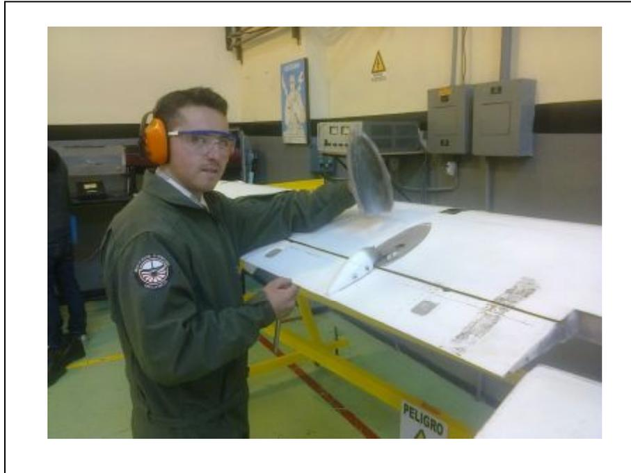
**Figura. 3.6** Extracción del fairing
