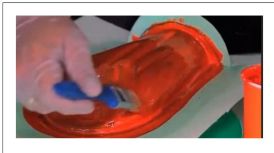
**Figura. 3.14** Aplicación del gelcoat
