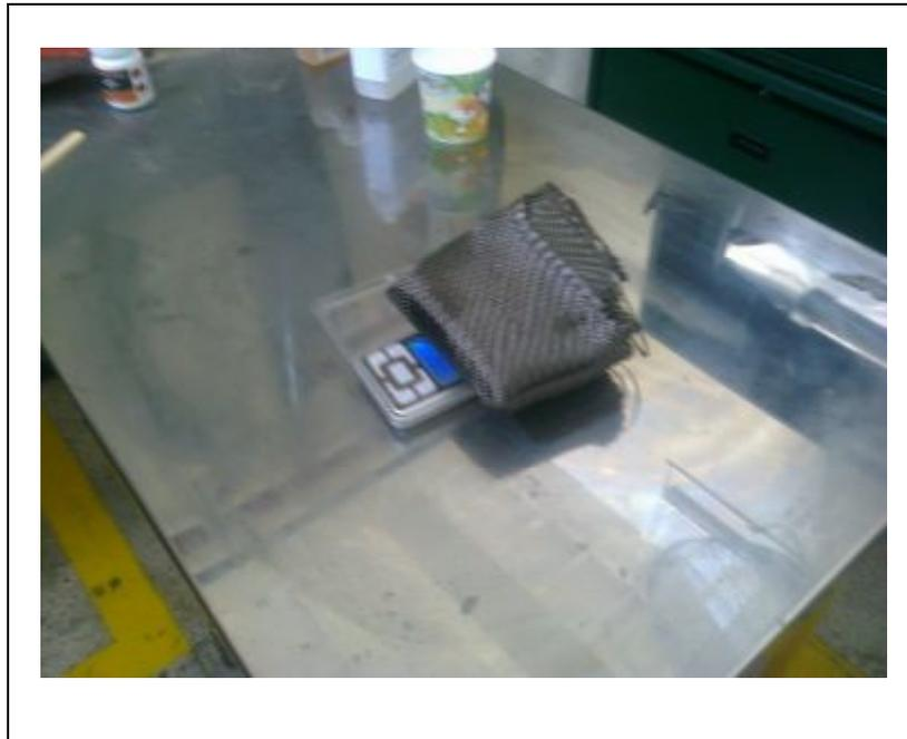
**Figura. 3.33** Proceso de pesado de fibra de carbono
