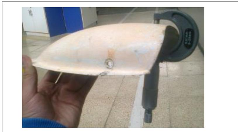
**Figura. 3.52** Medición del Espesor del Fairing de fibra de vidrio
