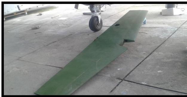
**Figura 33** Estabilizador horizontal
