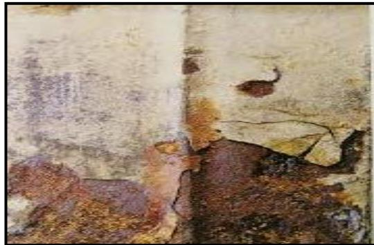
**Figura 10** Corrosión por Exfoliación
