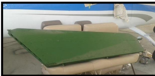
**Figura 32** Estabilizador vertical
