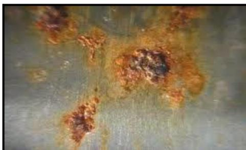
**Figura 8** Corrosión por Picadura
