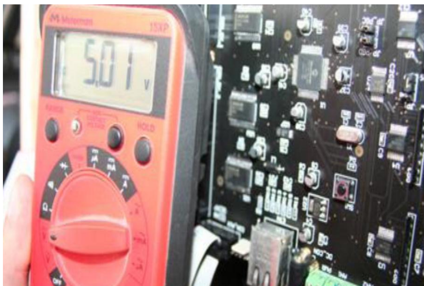
Figura 24: Test de entrada de voltaje a la placa.
