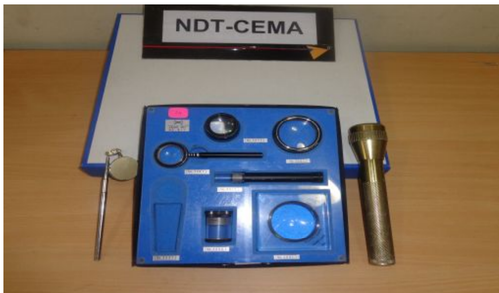
Figura 1. Equipos y accesorios utilizados para Inspección visual
