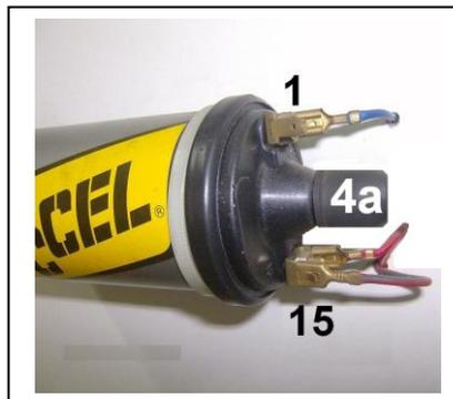
**Figura 1. Puntos de prueba de la bobina**
