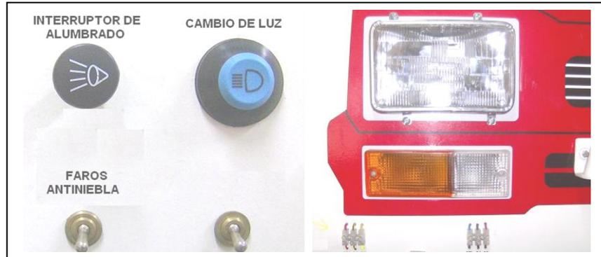
**Figura 4.6.- Instalación de luces de carretera**
