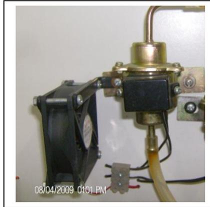
**Figura 4.45.- Instalación del sistema de ventilación del depósito de combustible**
