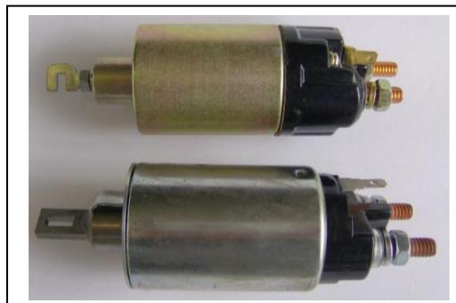
**Figura 2.57.- Solenoide del arranque**
