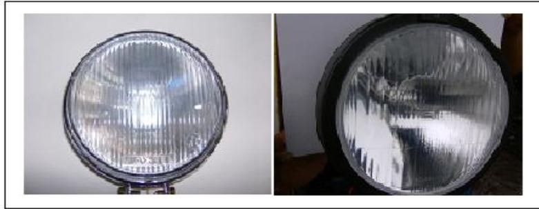
**Figura 2.7.- Halógenos de corta y larga distancia**
