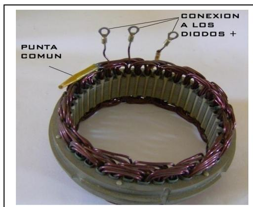
Figura 2.65.- Conexiones de un estator
