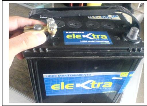
**Figura 4.40.- Instalación de la batería en el módulo**
