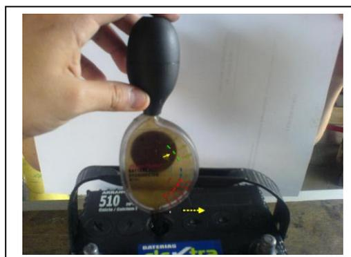
**Figura 2. Medición densidad del electrolito**
