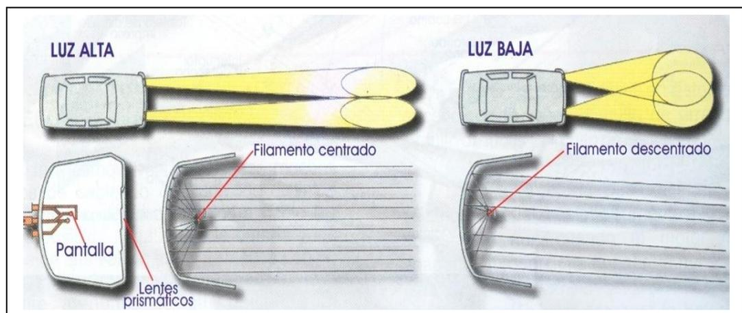
**Figura 2.4.- Variación de foco filamento alto-bajo**
