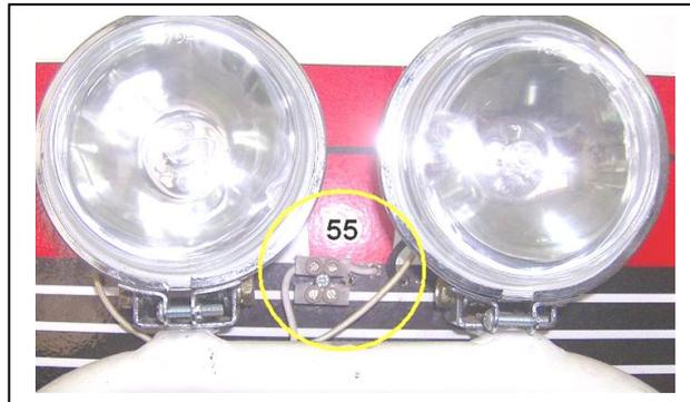
**Figura 4.8.- Instalación de faros antiniebla**
