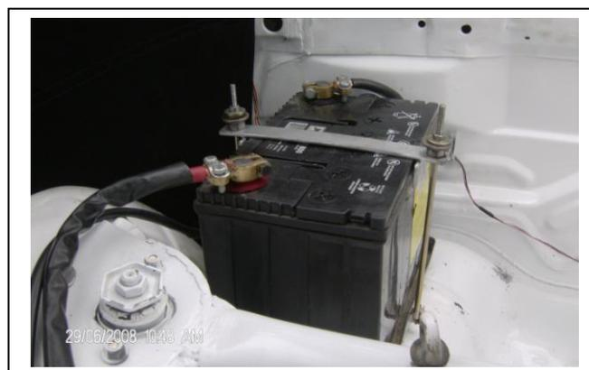
**Figura 2.32.- Ubicación batería en la parte posterior**
