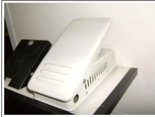
**Figura 4.25.- Switch-pedal acelerador**
