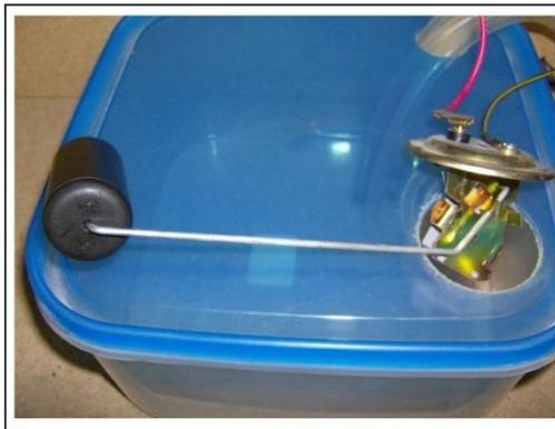
**Figura 4.24.- Medidor del nivel de combustible**
