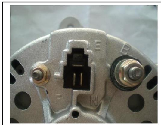
**Figura 4.36.- Conexiones del alternador**
