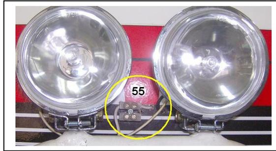
**Figura 2. Ubicación de bornes en luces antiniebla**
