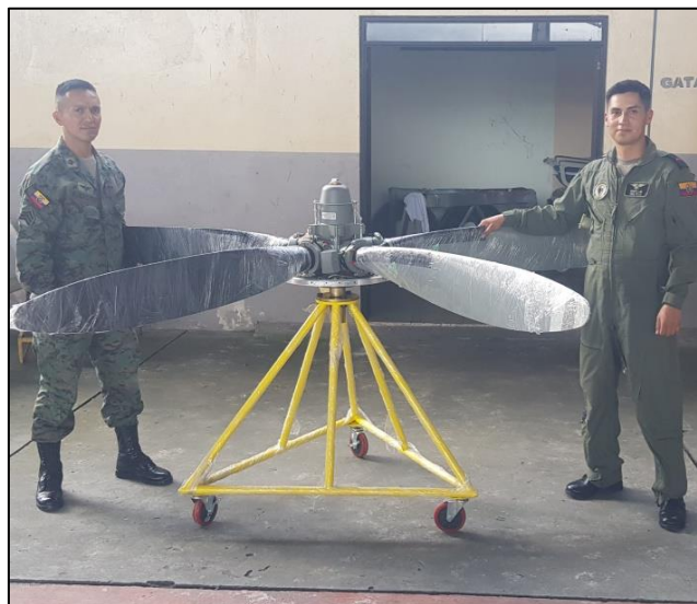
Figura 63. Montaje de la Hélice en el Soporte
