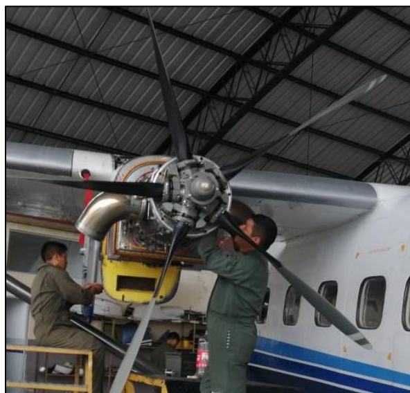
Figura 67. Inspección de fugas de aceite y grasa
