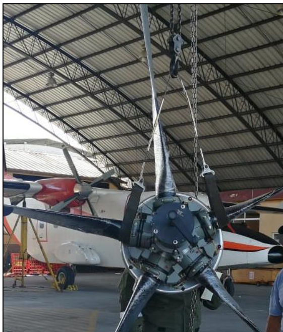
Figura 70. Hélice levantada con eslinga
