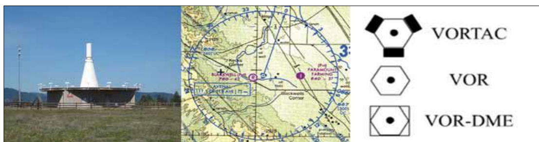
Figura 6. Representación estación VOR en tierra Fuente: (FAA, 2012)
