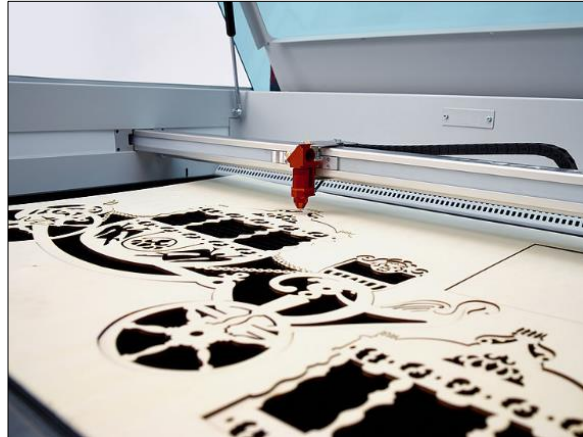
Figura 47. Proceso de corte por laser Fuente: (TROTEC, 2019)
