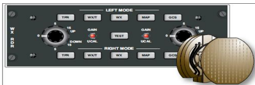
Figura 23. Sistema típico de radar meteorológico abordo Fuente: (FAA, 2012)
