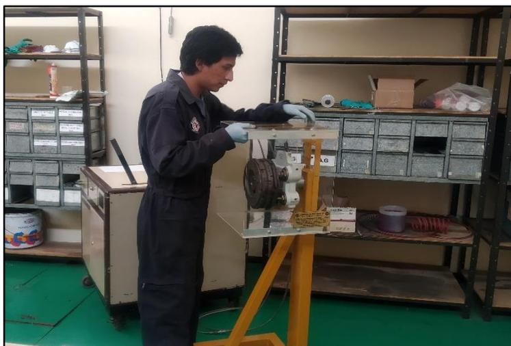
**Figura 34.** Instalación del soporte y escudo protector
