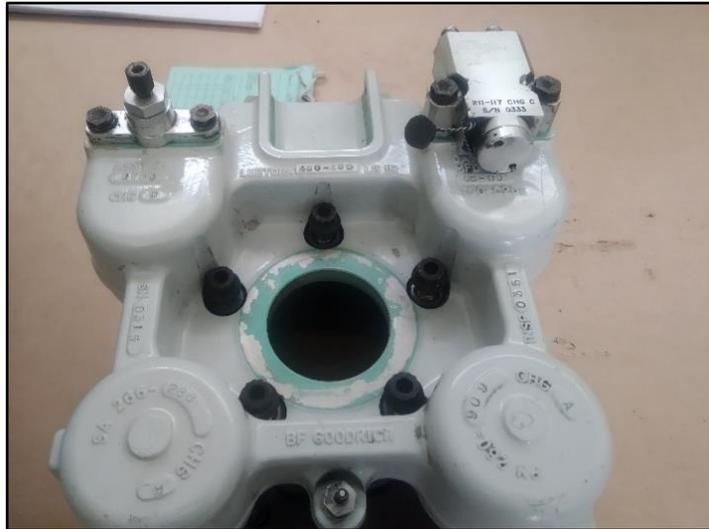
**Figura 47.** Terminar el ensamblaje del freno
