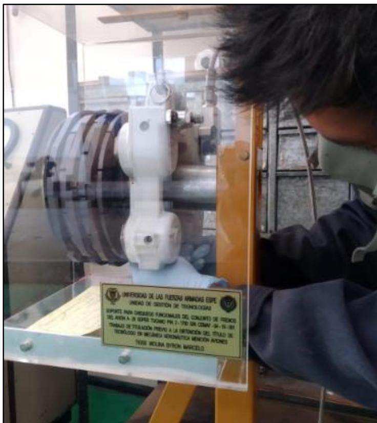
**Figura 56.** Medición del indicador de desgaste
