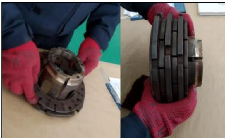
**Figura 46.** Instalación del disipador de calor
